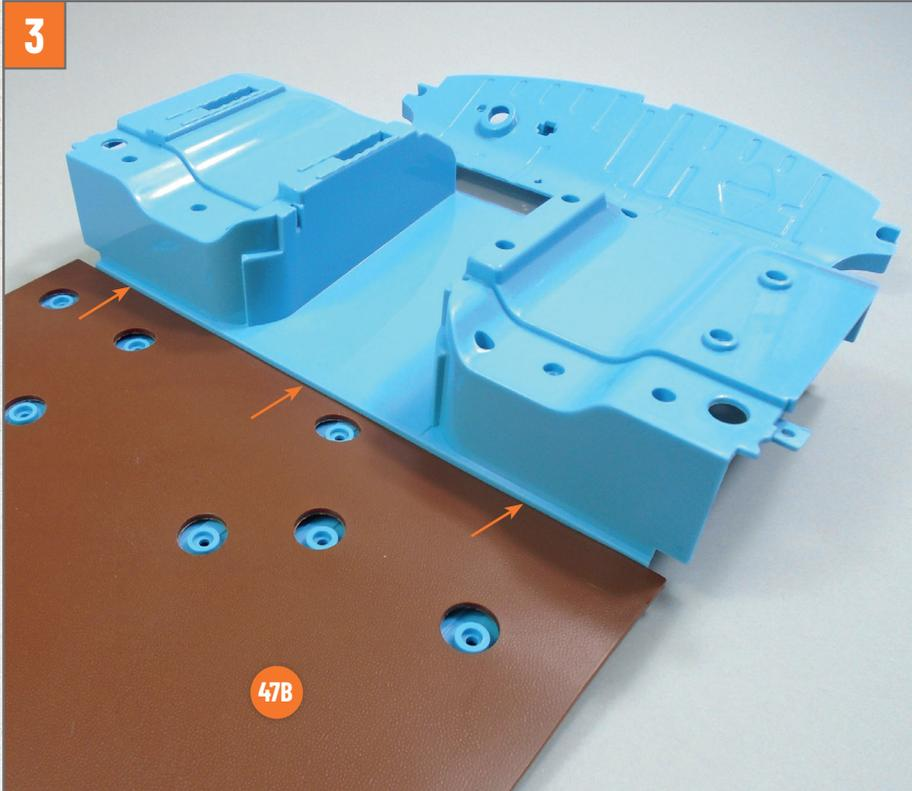
Kontrollieren Sie, ob der Bodenbelag **47B** mit dem Profil des Fahrgastraumbodens übereinstimmt. Verschieben Sie den Bodenbelag gegebenenfalls, um ihn auszurichten, und drücken Sie auf die Oberfläche, um ihn zu glätten.
