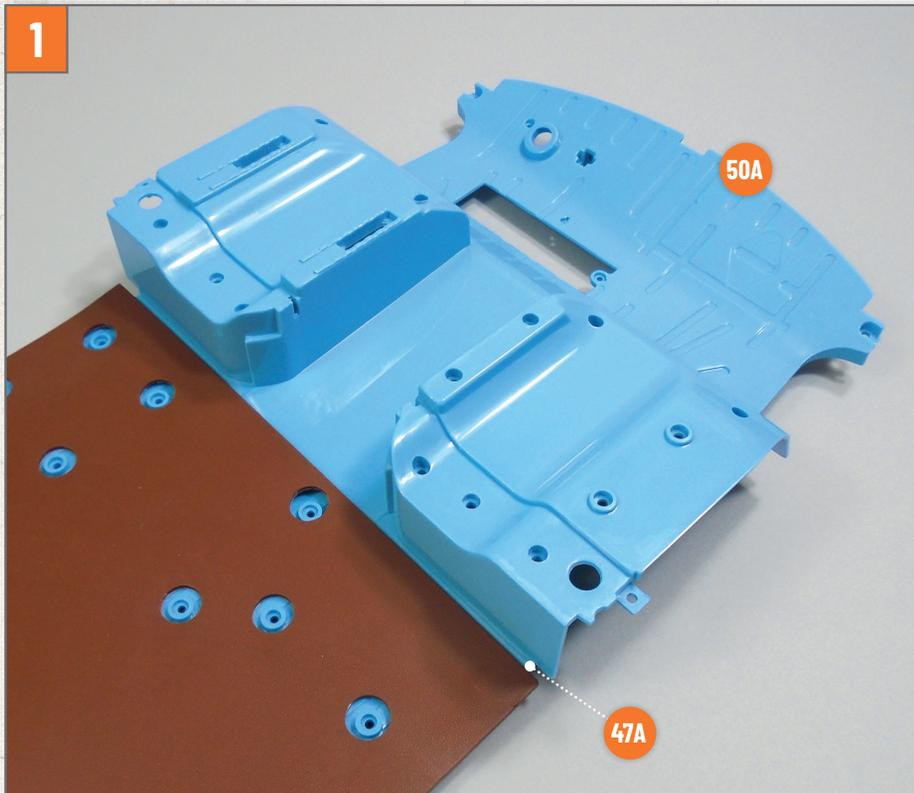
Nehmen Sie den Boden des zentralen Innenraums zur Hand, an dem Sie in Bauphase 49 gearbeitet haben. Verbinden Sie den Boden des Mittelbereichs **47A** mit dem des Fahrgastraums **50A**, indem Sie die vier gebohrten Zapfen in die entsprechenden Löcher stecken. Richten Sie die Teile dabei genau so wie auf dem Foto aus.
