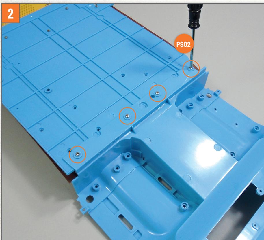
Drehen Sie die Baugruppe um und achten Sie darauf, dass sich die Komponenten dabei nicht verschieben. Befestigen Sie den Boden des Fahrgastraums am Boden des Mittelbereichs, indem Sie vier Schrauben **PS02** in den auf dem Foto durch Kreise gekennzeichneten Löchern festziehen.
