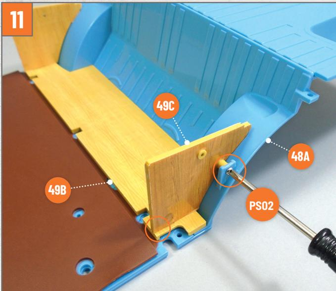
Montieren Sie die linke Seitenwand **49C** in der auf dem Foto gezeigten Stelle. Stecken Sie die Stifte der Seitenwand in die entsprechenden Öffnungen in der Bodenplatte **49B** und befestigen Sie die Seitenwand mit einer Schraube **PS02** am vorderen Abschlussblech des Motorraums **48A**.
