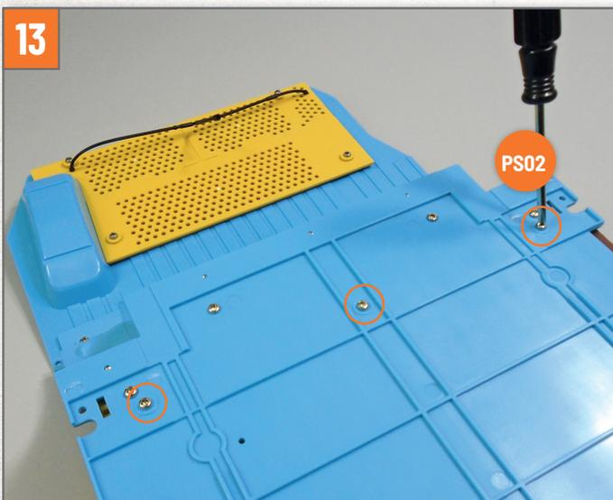
Drehen Sie die Baugruppe um und achten Sie darauf, dass sich die Platten nicht verschieben. Befestigen Sie die Teile, indem Sie drei Schrauben **PS02** in den auf dem Foto mit Kreisen markierten Löchern festziehen.
