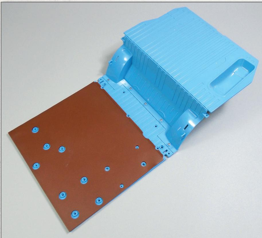
So sieht der Boden des zentralen Innenraums nach der Montage des vorderen und oberen Abschlussblechs aus.
