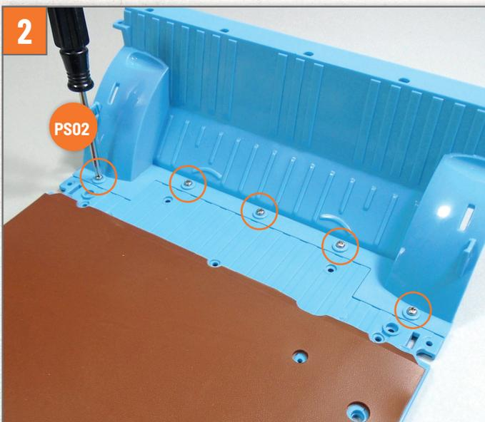
Ziehen Sie fünf Schrauben **PS02** in den auf dem Foto mit Kreisen markierten Löchern fest, um die Teile miteinander zu verbinden.
