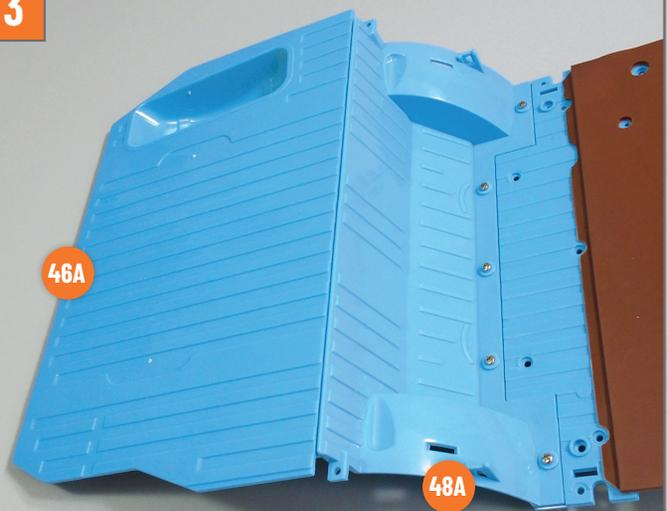
Nehmen Sie das obere Abschlussblech des Motorraums **46A** zur Hand, an dem Sie in Bauphase 46 gearbeitet haben. Verbinden Sie das obere Abschlussblech **46A** mit dem vorderen Abschlussblech **48A** und richten Sie die Teile wie auf dem Foto gezeigt aus.
