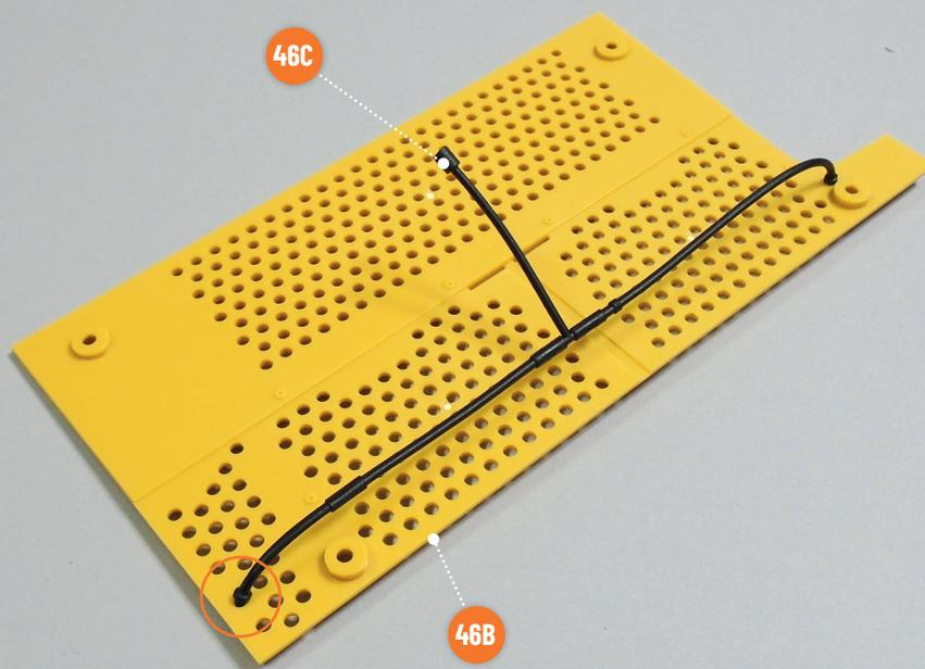
Stecken Sie das gegenüberliegende Ende des Elektrokabels **46C** in die im Foto eingekreiste Vertiefung im Lüftungsgitter **46B**.
