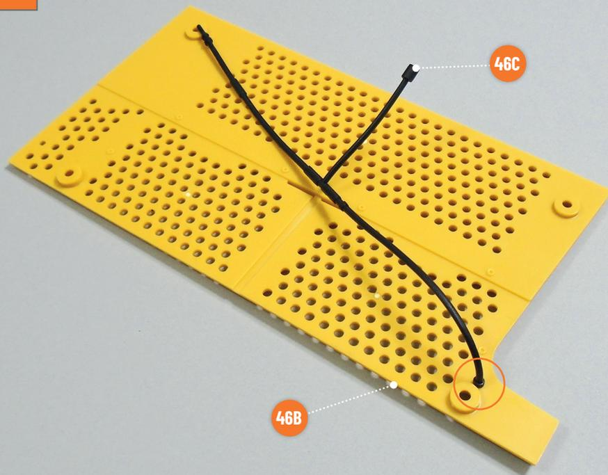
Richten Sie das Elektrokabel **46C** wie auf dem Foto gezeigt aus und stecken Sie das entsprechende Ende des Kabels in die eingekreiste Vertiefung im Lüftungsgitter **46B**. Achten Sie darauf, dass das Ende des Kabels vollständig eingesteckt ist.
