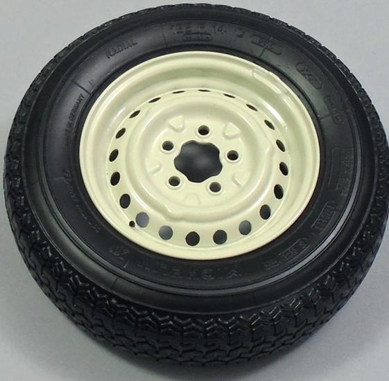
Drehen Sie die Felge schrittweise im Reifen, bis die Ränder des Reifens korrekt auf beiden Seiten der Felge sitzen.
