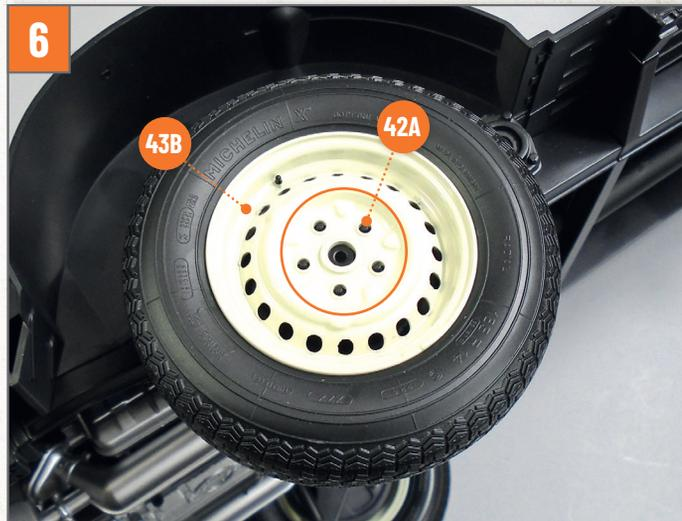
6 Montieren Sie das Rad an die hintere rechte Bremstrommel **42A**, indem Sie die fünf Stifte der Bremstrommel in die entsprechenden Löcher der Außenfelge **43B** stecken.
