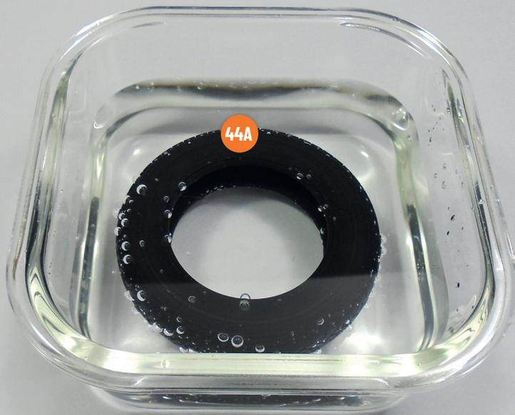
Legen Sie den Reifen **44A** für etwa zehn Minuten in einen Behälter mit heißem Wasser, um das Gummi formbarer zu machen. Alternativ können Sie auch einen Fön verwenden.
