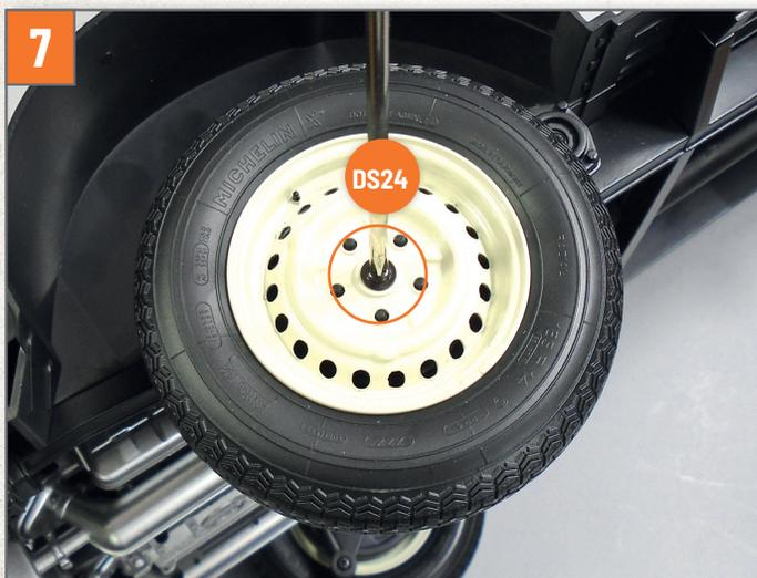
7 Befestigen Sie das Rad am Stift der Federstrebe, indem Sie eine Schraube **DS24** im gezeigten Loch festziehen.
