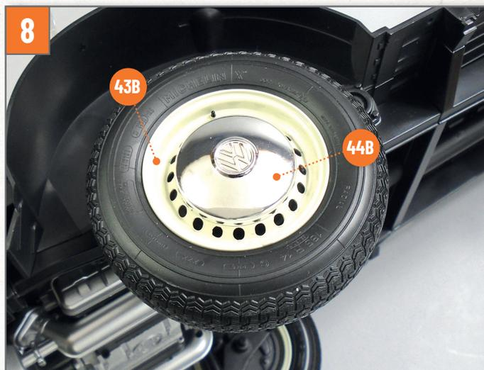
8 Montieren Sie die Radkappe **44B** auf das Rad. Richten Sie die Teile dabei wie auf dem Foto gezeigt aus. Die Radkappe sitzt dank eines Magnets und drei Kerben an der Innenseite der Radkappe an der Außenfelge **43B** fest.
