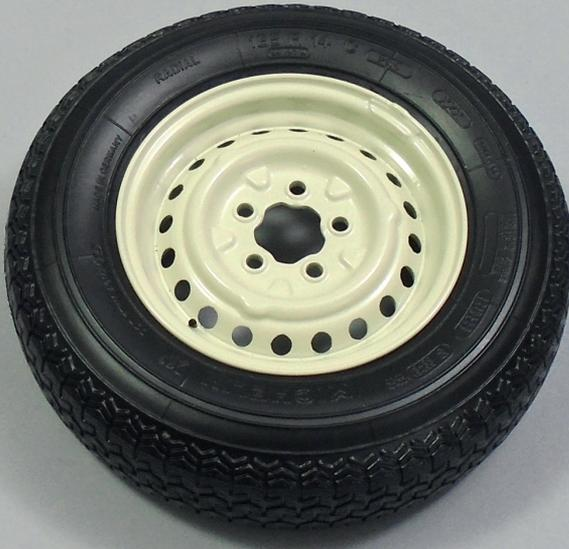
Drehen Sie die Felge schrittweise im Reifen, bis die Ränder des Reifens korrekt auf beiden Seiten der Felge sitzen.
