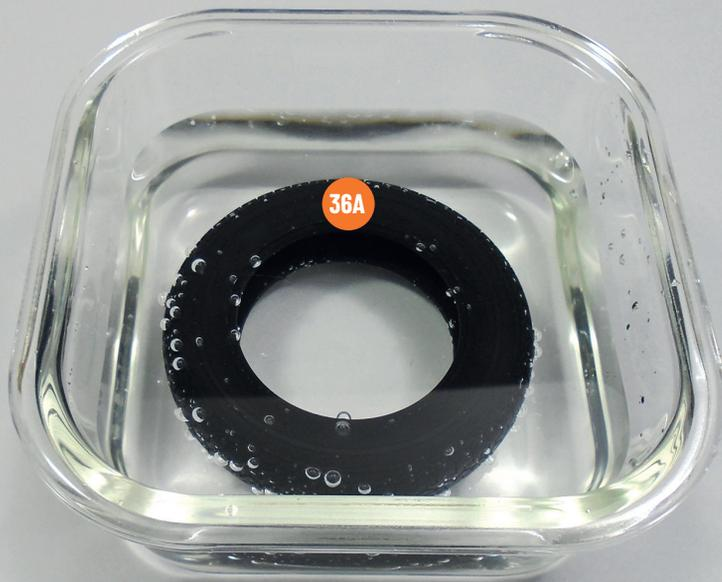
Legen Sie den Reifen **36A** für etwa zehn Minuten in einen Behälter mit heißem Wasser, um das Gummi formbarer zu machen. Alternativ können Sie auch einen Fön verwenden.
