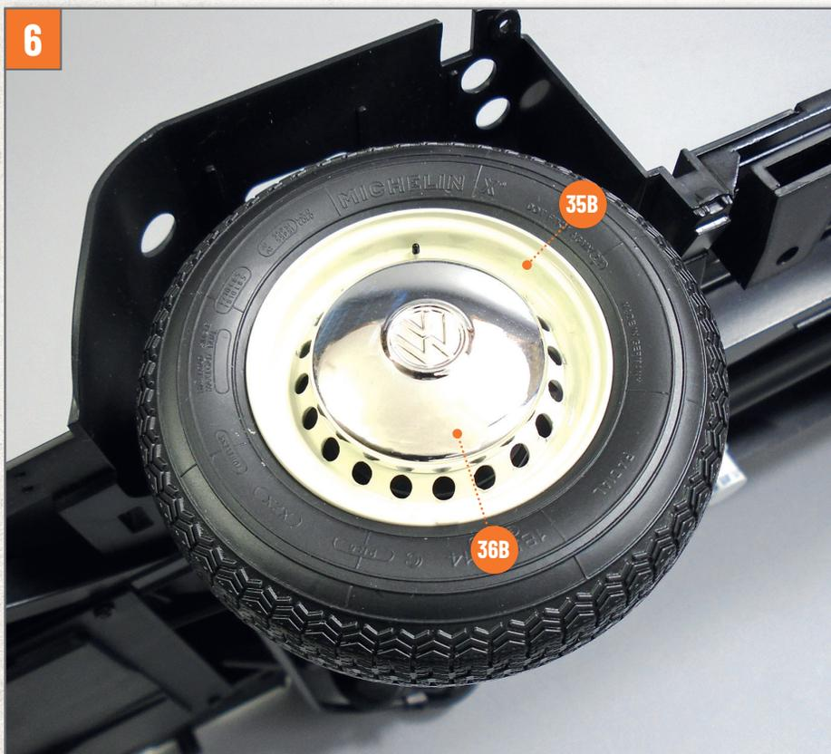
Montieren Sie die Radkappe **36B** auf das Rad und richten Sie die Teile dabei wie auf dem Foto gezeigt aus. Die Radkappe ist mit einem Magneten ausgestattet und verfügt an der Innenseite über drei Kerben, sodass sie fest an der Außenfelge **35B** sitzt.
