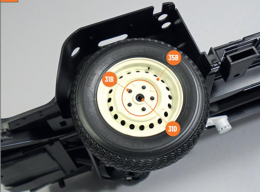
Nehmen Sie die Bodengruppe Ihres Modells zur Hand. Montieren Sie das Rad auf den vorderen linken Achsschenkel **31D**, indem Sie die fünf Stifte der Bremsscheibe **31B** in die entsprechenden Löcher der Außenfelge **35B** stecken.
