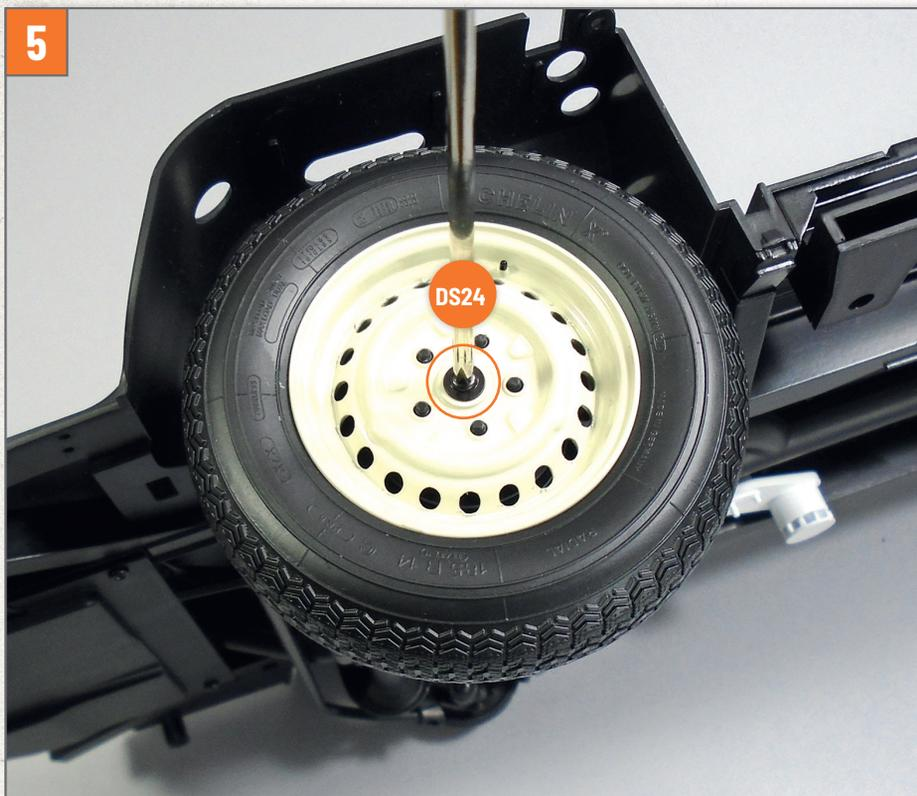
Befestigen Sie das Rad am Achsschenkel, indem Sie eine Schraube **DS24** in dem auf dem Foto gezeigten Loch festziehen.
