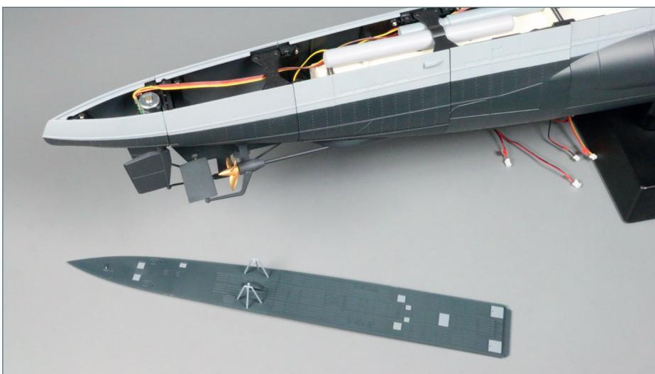
**Die beiden achtersten Abschnitte des Oberdecks sind aneinander befestigt. Die Ruderhacke und die Abweiserstangen sind am Heck des Modells angebracht.**
