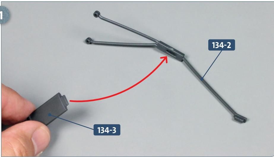
Legen Sie die Abweiserstangen **134-2** auf Ihre Arbeitsplatte, ausgerichtet wie abgebildet. Nehmen Sie die Ruderhacke **134-3**, versehen Sie den schmaleren Zapfen mit etwas Sekundenkleber und fügen Sie ihn in die Aufnahme der Abweiserstangen ein, wie es der Pfeil andeutet.
