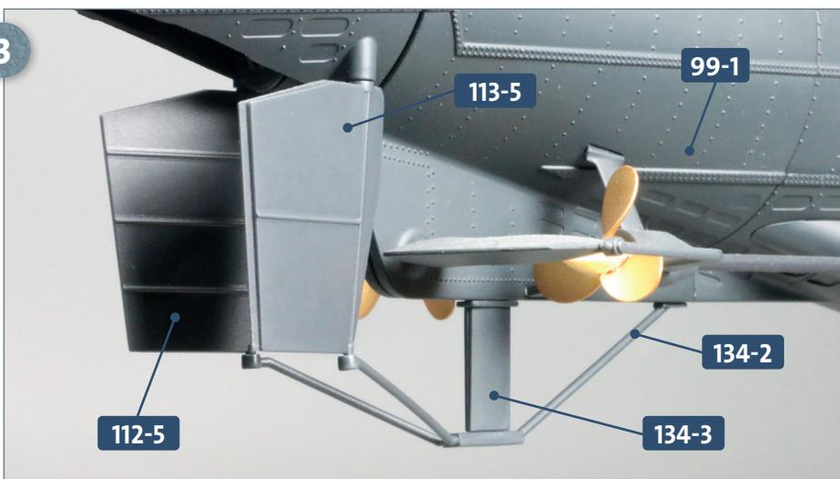
Geben Sie etwas Klebstoff auf den breiten Zapfen am vorderen Ende der Abweiserstangen **134-2** und auf den breiten Zapfen am oberen Ende der Ruderhacke **134-3** und fügen Sie diese in die Aussparungen an der Unterseite der Rumpfabschnitte **99-1** und **98-1** (nicht abgebildet) ein. Die Ösen am hinteren Ende der Abweiserstangen nehmen die Zapfen unten an den beiden Seitenrudern **112-5** und **113-5** auf. Tragen Sie dort keinen Klebstoff auf!
