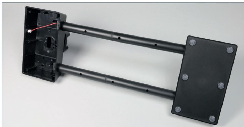
Die Kabel im hinteren Ständerkorpus sind mit der Platine verbunden. Das Unterteil des Korpus ist montiert und mit Elastikpuffern versehen.
