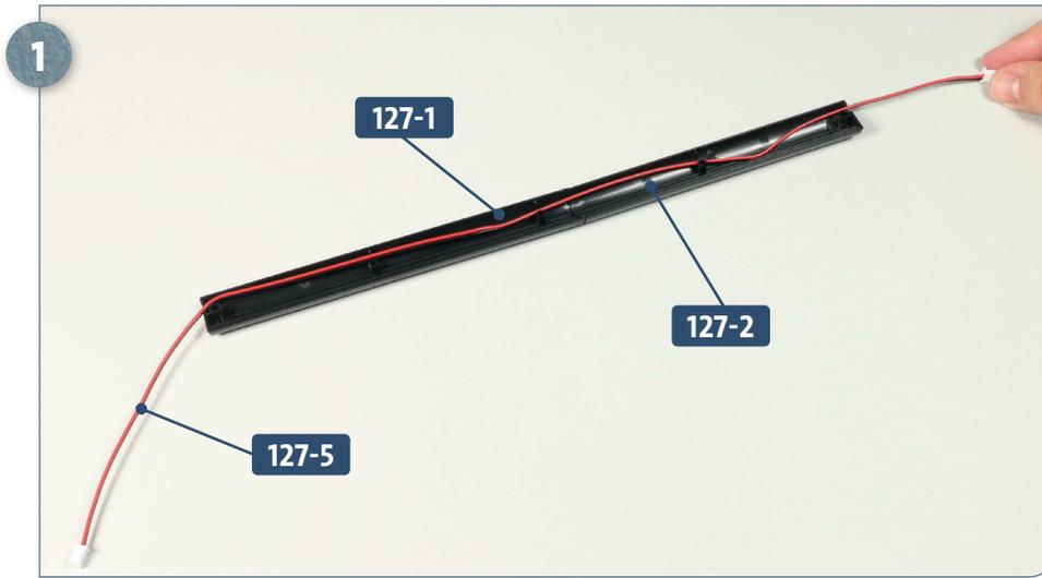
Legen Sie die beiden oberen Abschnitte des Längsträgers **127-1** und **127-2** aneinander, wie abgebildet. In den beiden Abschnitten platzieren Sie das Kabel **127-5**. Achten Sie dabei darauf, dass es um die Schraubenaufnahmen in beiden Abschnitten des Längsträgers herumgeführt wird.
