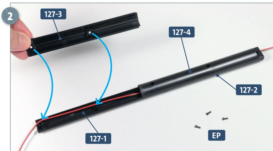
Setzen Sie die beiden unteren Abschnitte des Längsträgers **127-3** und **127-4** auf die oberen Abschnitte **127-1** und **127-2**: Die beiden langen Abschnitte **127-1** und **127-4** überlappen in der Mitte des Trägers. Legen Sie drei Schrauben **EP** bereit.
