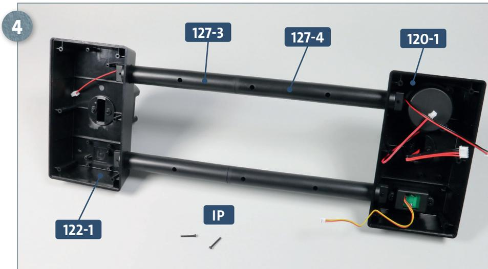
Positionieren Sie die Ständer-Baugruppe, die Sie zuletzt mit Ausgabe 126 bearbeitet haben, auf Ihrer Arbeitsplatte. Platzieren Sie den zweiten Längsträger so in den Aussparungen des vorderen und des hinteren Ständerkorpus **122-1** und **120-1**, dass die unteren Abschnitte **127-3** und **127-4** nach unten weisen. Legen Sie zwei Schrauben **IP** bereit.
