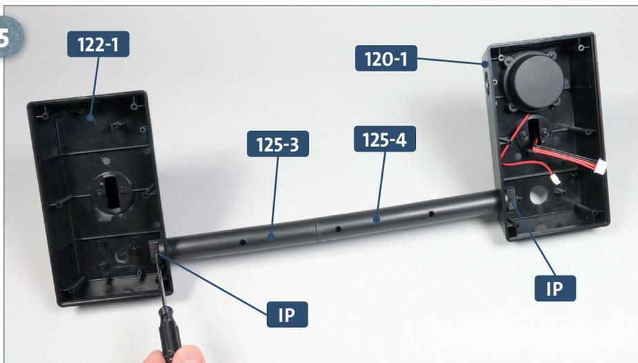
Befestigen Sie den Längsträger **125-3/125-4** an den beiden Ständerkorpora **122-1** und **120-1**, indem Sie in die Bohrungen an den beiden Trägerenden je eine der Schrauben **IP** eindrehen, wie es das Foto zeigt.
