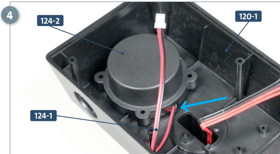
Setzen Sie die Halterung **124-2** so über dem Lautsprecher **124-1** auf, dass sich ihre vier Laschen über den Schraubenaufnahmen des Ständerkorpus **120-1** befinden. Achten Sie dabei darauf, dass das Kabel des Lautsprechers durch die Aussparung der Halterung geführt wird. Der Pfeil weist auf die Stelle.
