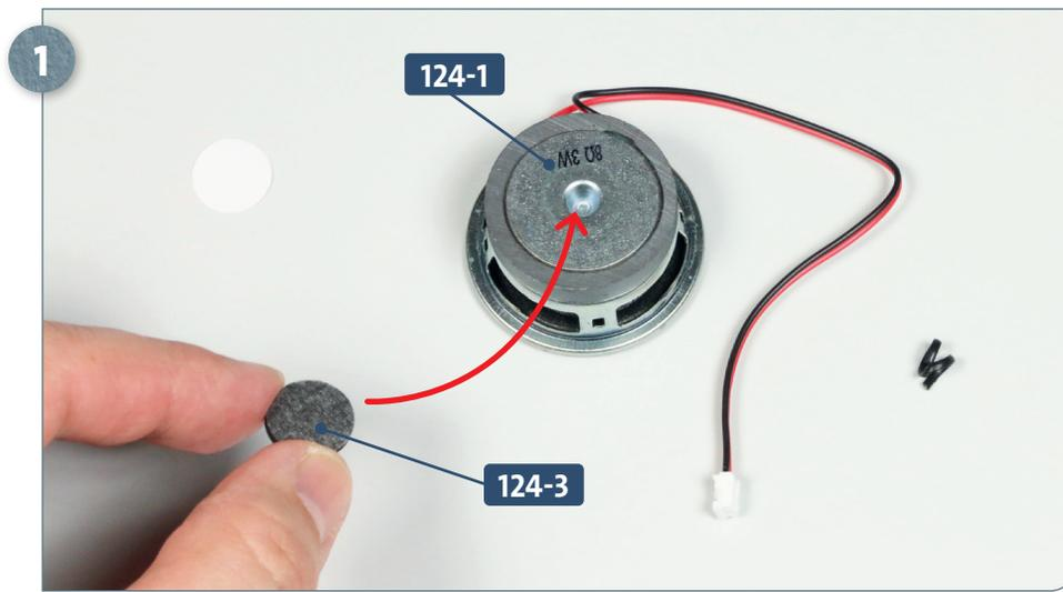
Nehmen Sie den Lautsprecher **124-1** und entfernen Sie den Draht von seinem Kabel. Lösen Sie die Trägerfolie von der Polsterung **124-3** und führen Sie die Polsterung zum Lautsprecher, wie angedeutet.
