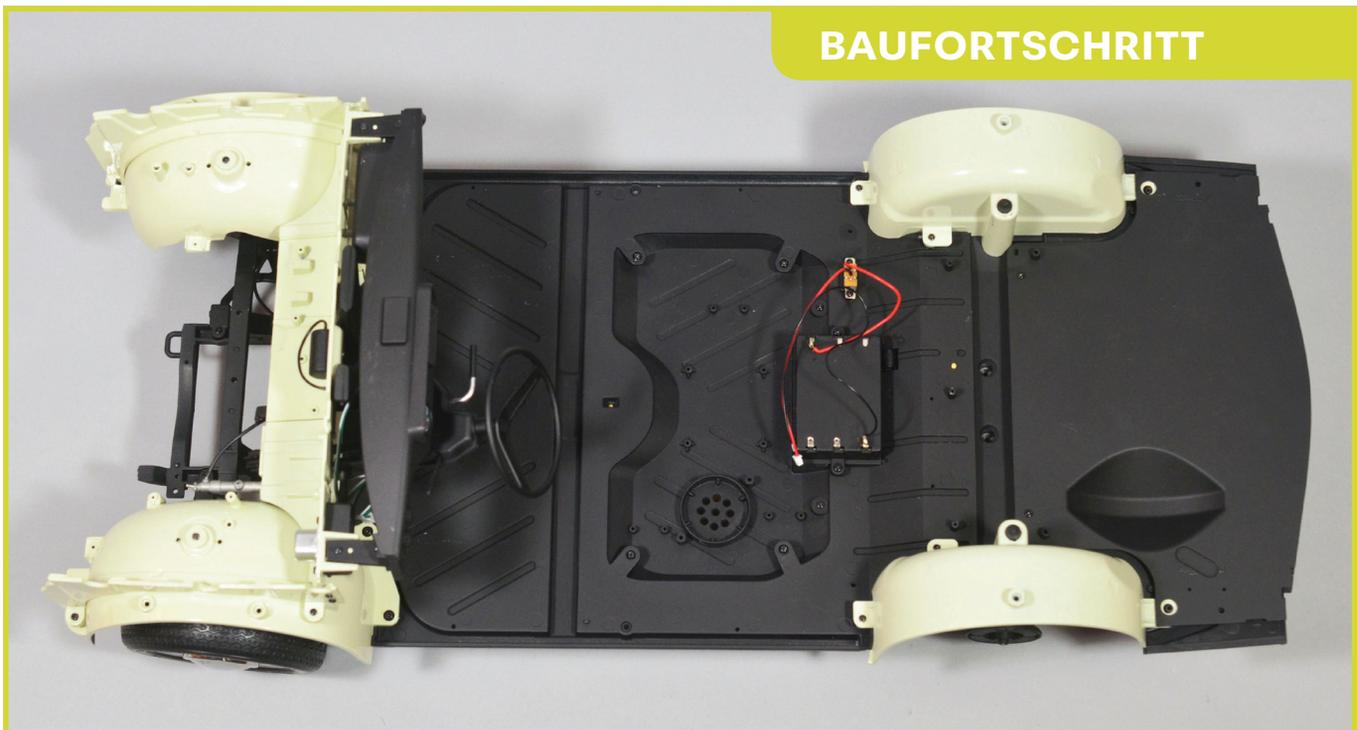
Die Montage des Kofferraumbodens ist abgeschlossen. Bewahren Sie die Baugruppe sorgfältig auf, bis Sie weiter daran arbeiten.
