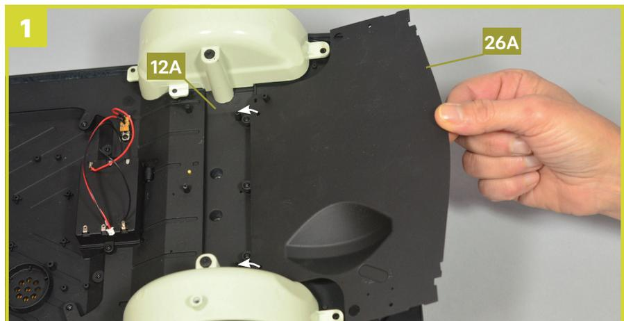
Positionieren Sie den Boden des Kofferraums **26A** wie durch die Pfeile angedeutet auf dem mittleren Bodenblech **12A**. Richten Sie dabei die Verbindungsstellen beider Teile aneinander aus.
