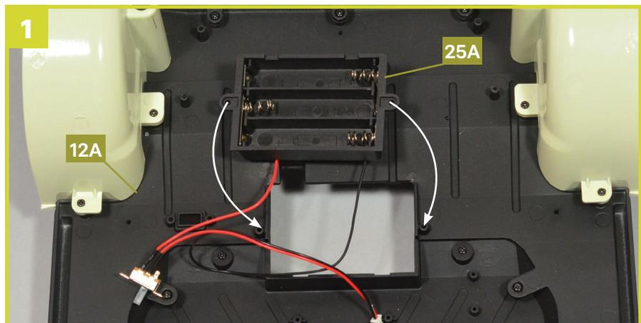
Platzieren Sie das Batteriefach mit Schalter **25A** auf dem mittleren Bodenblech **12A**, wie es die Pfeile andeuten. Die Bohrlöcher beider Teile müssen fluchten.
