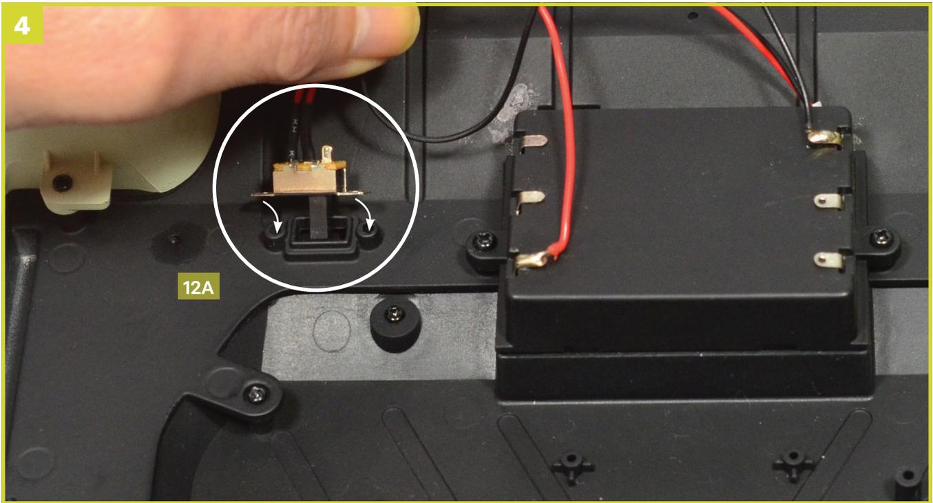
Passen Sie die Aussparungen am Schalter an den gebohrten Zapfen des mittleren Bodenblechs **12A** an. Achten Sie darauf, dass der Schalter genau wie auf dem Bild ausgerichtet ist.
