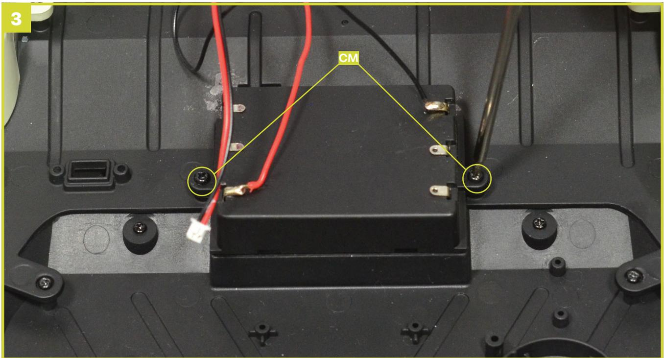
Fixieren Sie das Batteriefach **25A** mit zwei Schrauben **CM** am mittleren Bodenblech **12A**.
