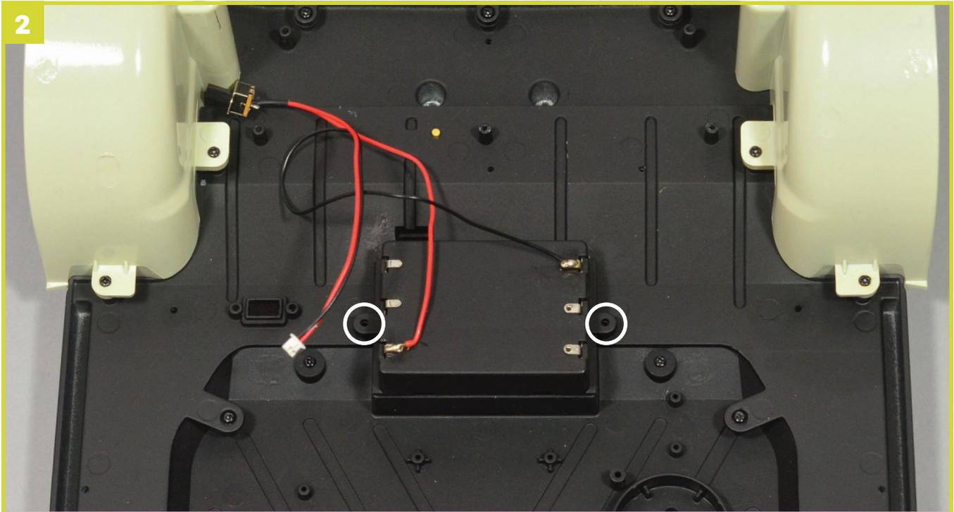
Das Bild zeigt die fluchtenden Bohrlöcher (weiße Kreise). Achten Sie darauf, dass der Schalter und die beiden Kabel außen liegen und nicht im Batteriefach eingeklemmt sind.
