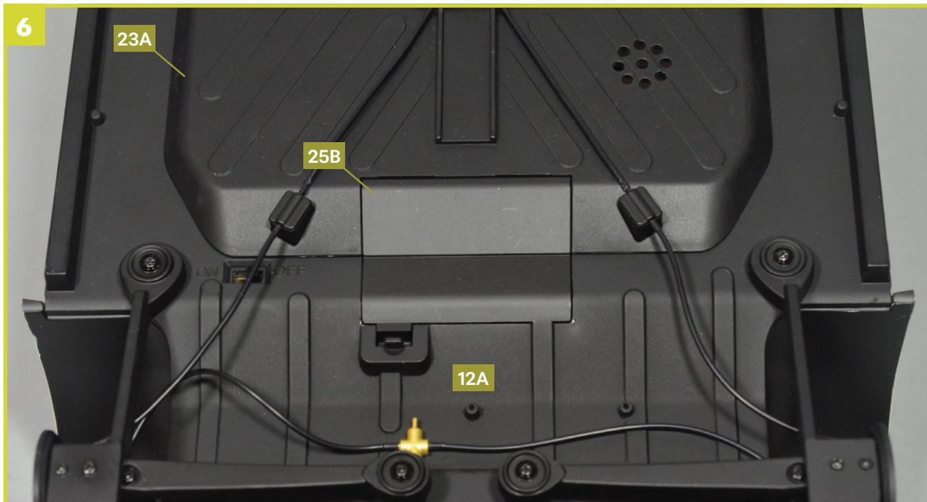
Verschließen Sie das Batteriefach 25A mit dem Deckel 25B.
