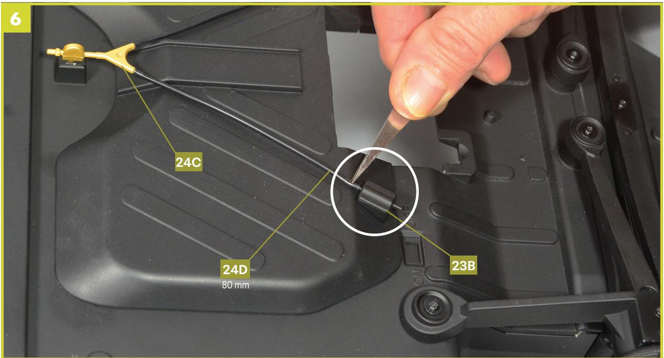
Verbinden Sie das Ende des zweiten 80 mm langen Schlauchs **24D** mit dem Verbindungsstück (links) **23B**.
