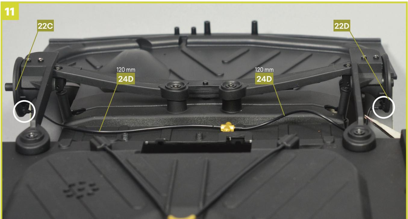
Verbinden Sie die beiden freien Enden der 120 mm langen Schläuche, die vom Verteiler **24A** ausgehen, wie gezeigt mit den Bremsankerplatten **22C** und **22D**.
