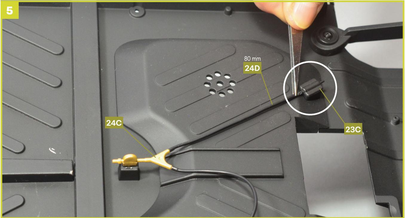
Verbinden Sie das freie Ende des 80 mm langen Schlauchs **24D** wie gezeigt am Verbindungsstück (rechts) **23C**.
