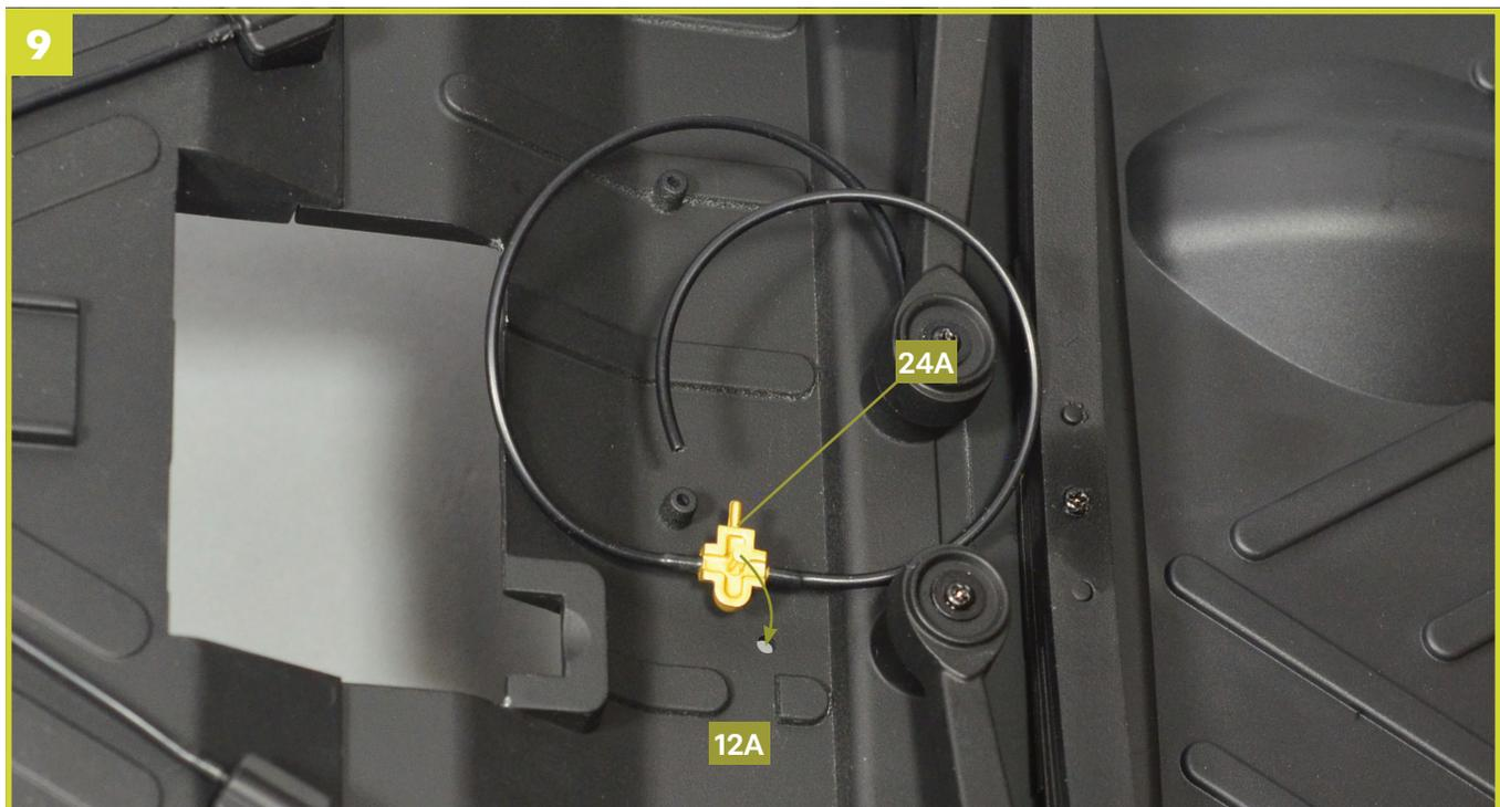
Bringen Sie den Verteiler **24A** wie angedeutet an dem gezeigten Loch im mittleren Bodenblech **12A** an.
