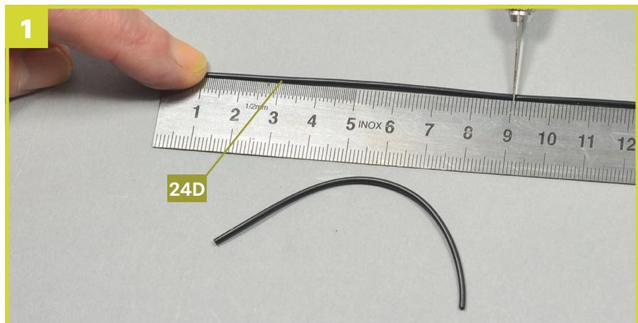
Schneiden Sie vom Schlauch **24D** jeweils zwei 90 mm lange Stücke, zwei 120 mm lange Stücke und zwei 80 mm lange Stücke ab.
