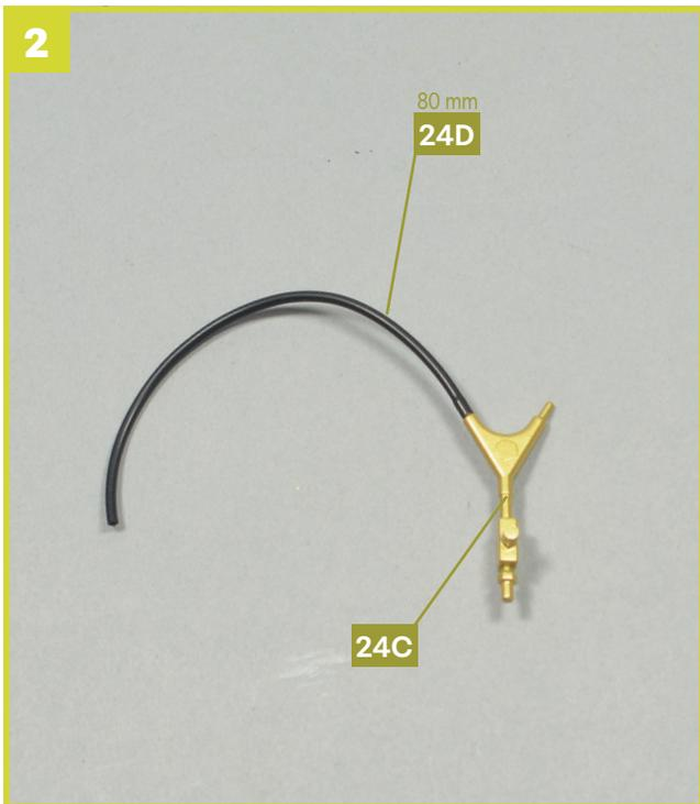
Setzen Sie das Ende eines 80 mm langen Schlauchs **24D** auf ein Ende der Seilführung Handbremsseil **24C**.
