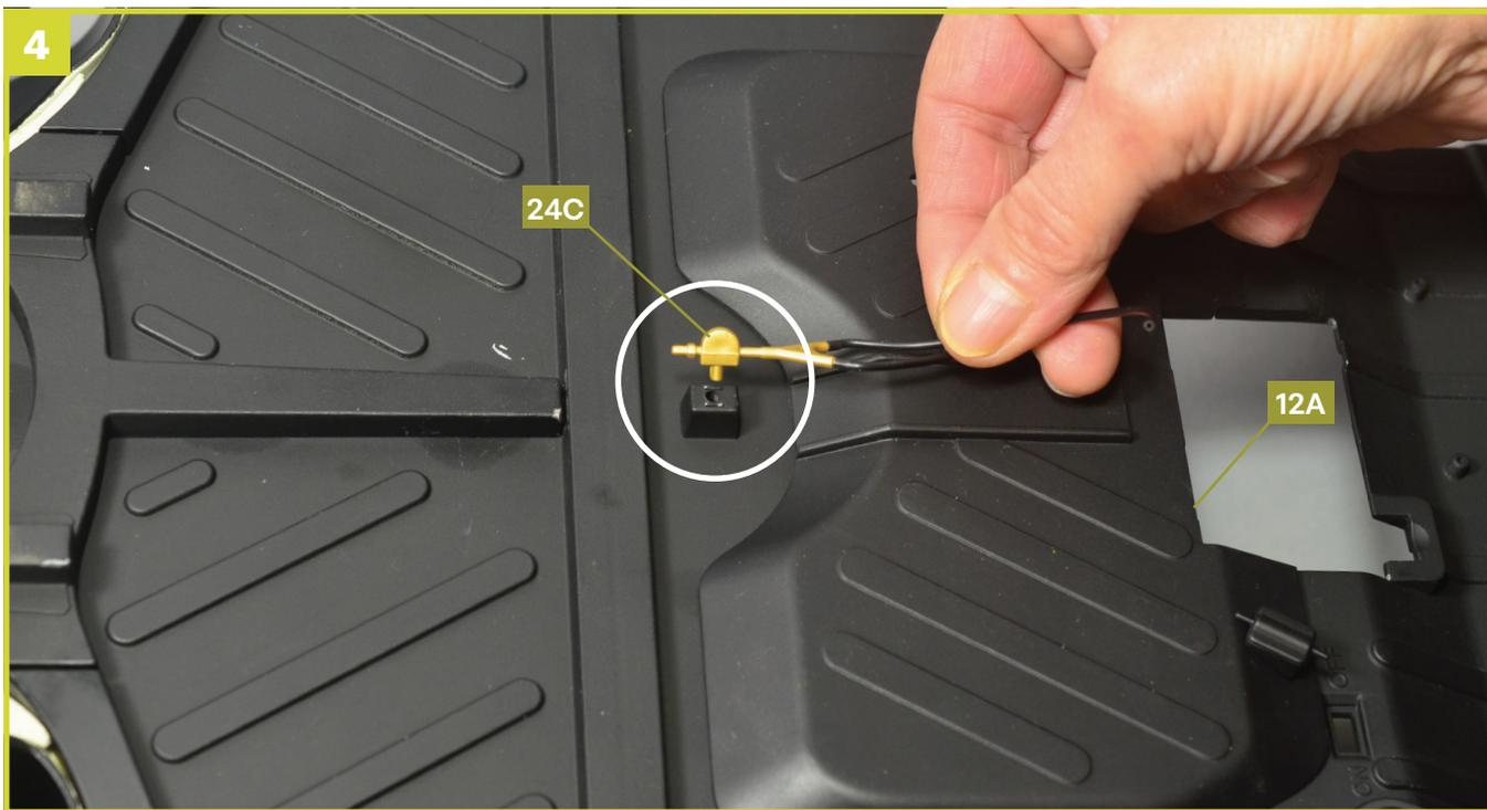
Setzen Sie den Zapfen der Seilführung Handbremsseil **24C** in das entsprechende Loch im mittleren Bodenblech **12A**.
