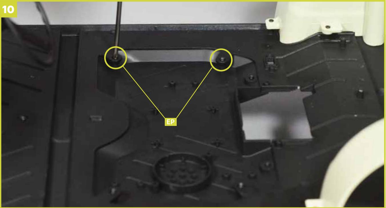
Ziehen Sie zwei weitere Schrauben **EP** an den gezeigten Stellen fest, um die Montage der Fußmulde **23A** am mittleren Bodenblech **12A** abzuschließen.
