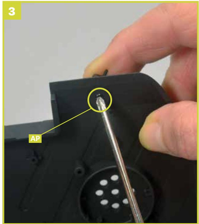
Drehen Sie von der Innenseite der Fußmulde eine Schraube **AP** ein, um das Verbindungsstück zu fixieren.
