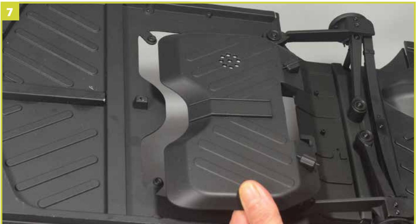
Drehen Sie die Fußmulde **23A** um und richten Sie sie entsprechend ihrer Verbindungsstellen am mittleren Bodenblech **12A** aus.
