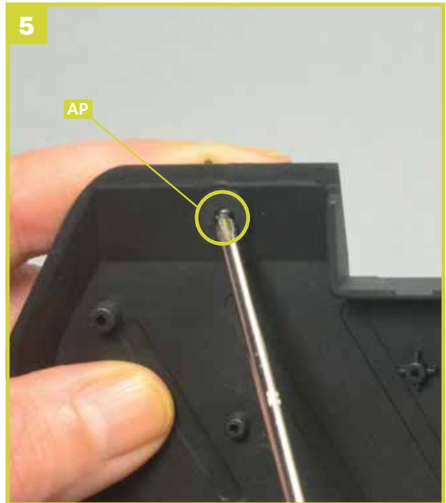
Ziehen Sie von der Innenseite der Fußmulde eine Schraube **AP** fest, um das Verbindungsstück zu fixieren.
