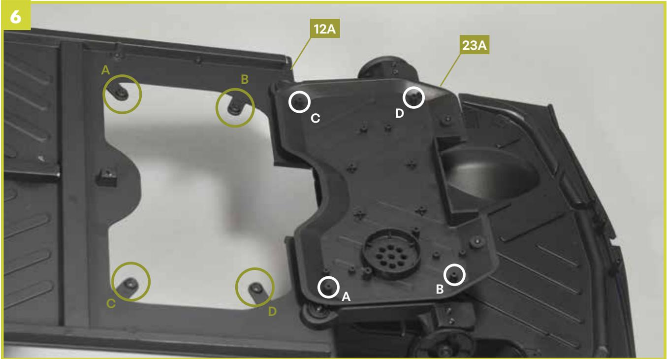
Das Bild zeigt die vier Verbindungsstellen, mit denen die Fußmulde **23A** im nächsten Schritt mit dem mittleren Bodenblech **12A** verbunden wird. Die Buchstaben helfen Ihnen, die Verbindungsstellen beider Teile korrekt auszurichten.
