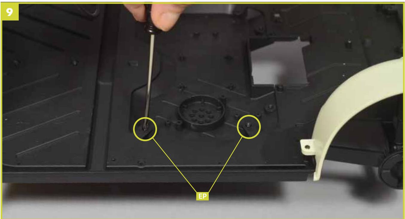
Drehen Sie die Baugruppe vorsichtig um und ziehen Sie zwei Schrauben **EP** in den im Bild eingekreisten Löchern fest.
