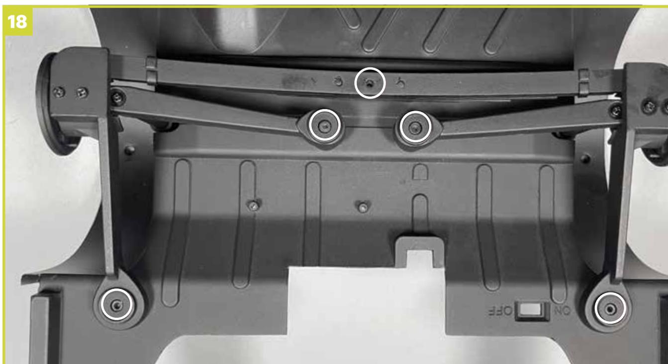
Prüfen Sie, dass alle fünf Befestigungspunkte (eingekreist) korrekt aneinander ausgerichtet sind, bevor Sie fortfahren.
