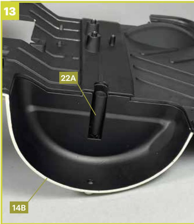
Setzen Sie die verbleibende Schutzkappe **22A** wie gezeigt in den rechten hinteren Radkasten **14B**.
