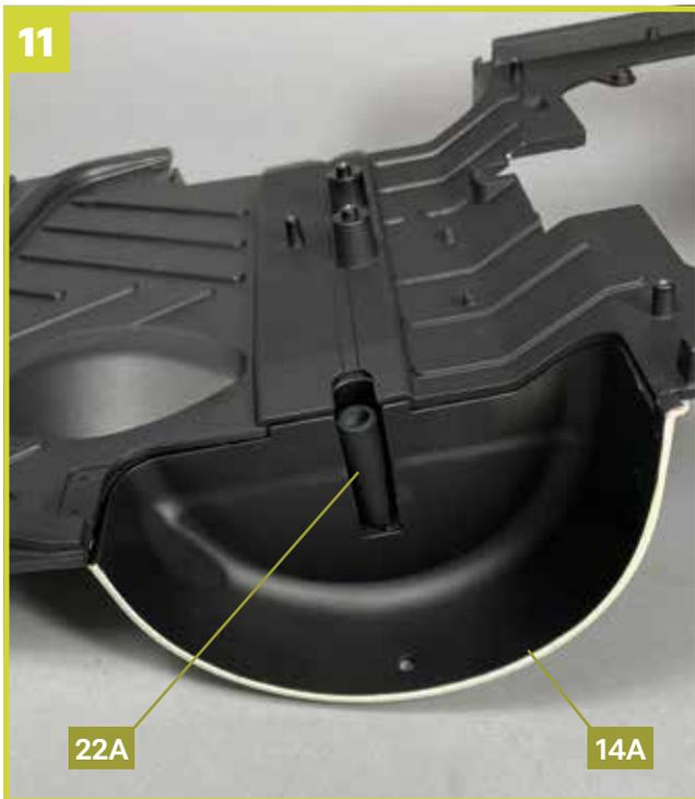
Setzen Sie eine Schutzkappe **22A** wie gezeigt in den linken hinteren Radkasten **14A**.
