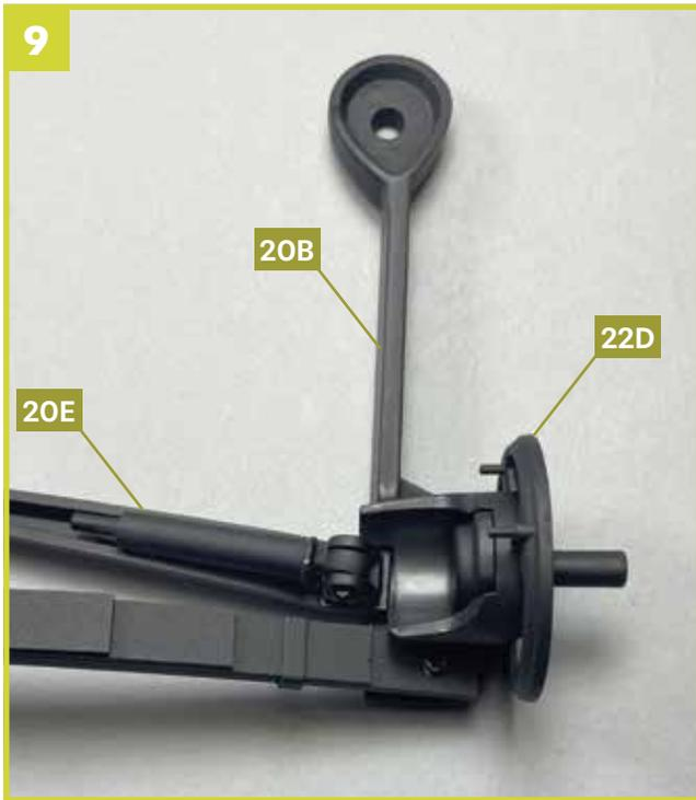
Positionieren Sie nun die Bremsankerplatte (rechts) **22D** wie auf dem Foto gezeigt.
