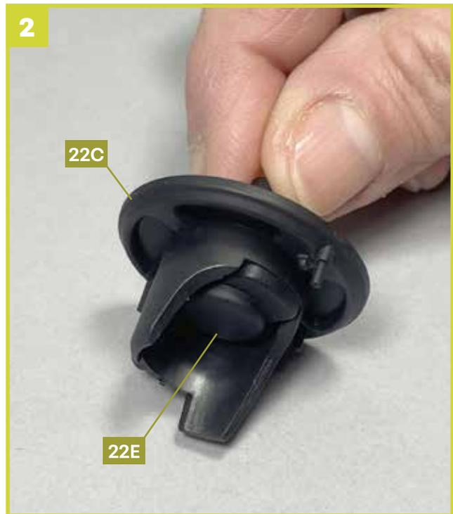
Setzen Sie den Radbefestigungsbolzen **22E** wie gezeigt in die linke Bremsankerplatte **22C**.
