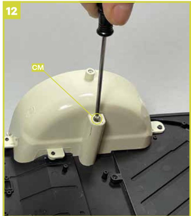
Befestigen Sie die Schutzkappe **22A** mit einer Schraube **CM**.
