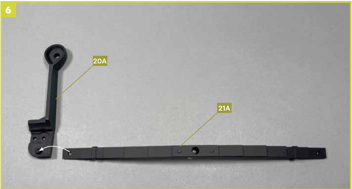
6 Setzen Sie ein Ende der hinteren Blattfeder **21A** wie angedeutet auf den hinteren Lenkerarm A (links) **20A** und richten Sie die Aussparungen der beiden Teile aneinander aus.
