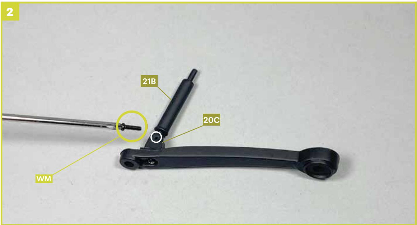
Führen Sie eine Schraube **WM** durch das Loch des Lagerblocks **20C** und die Öse des Drehknebels **21B**. Achtung: Die Schraube gehört in das größere Loch des Lagerblocks **20C**.
