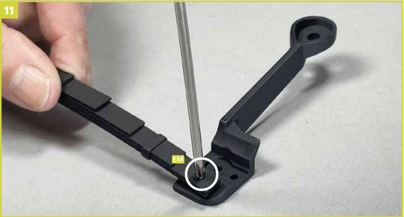
Fixieren Sie beide Teile mit einer Schraube **EM** aneinander.
