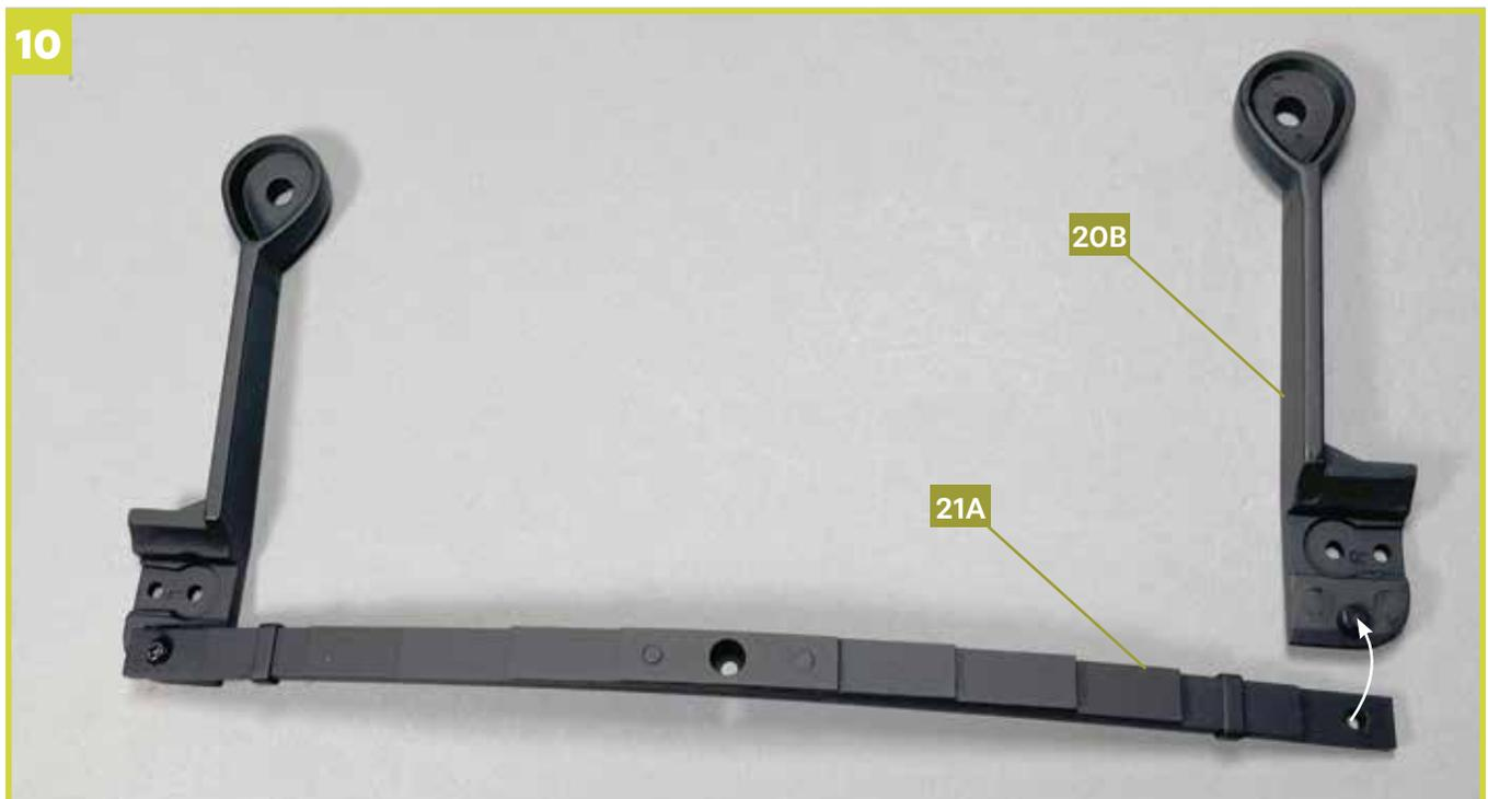
Setzen Sie nun das andere Ende der hinteren Blattfeder **21A** auf den hinteren Lenkerarm A (rechts) **20B**. Richten Sie die Aussparungen beider Teile aneinander aus.
