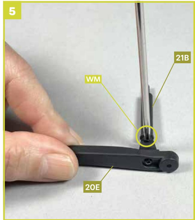
5 Setzen Sie eine Schraube **WM** in das größere Loch des Lagerblocks **20C**. Ziehen Sie die Schraube **WM** nicht zu fest an, damit der Drehknebel **21B** beweglich bleibt.
