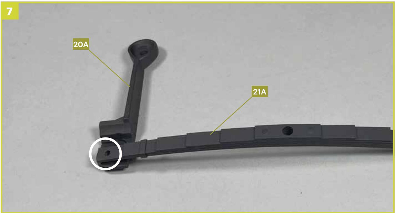
Achten Sie darauf, dass der hintere Lenkerarm A (links) **20A** und die hintere Blattfeder **21A** korrekt aneinander ausgerichtet sind.
