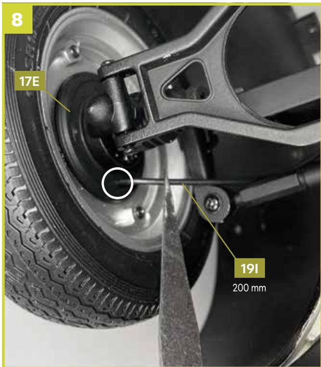
Das andere Ende des 200 mm langen Schlauchs gehört in das gezeigte Ventil der Bremstrommel **17E**.
