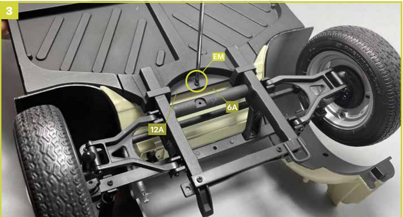
Fixieren Sie das mittlere Bodenblech **12A** am Spritzwand-Unterteil **6A**, indem Sie eine Schraube **EM** festziehen.
