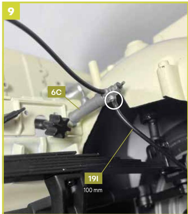
Setzen Sie ein Ende des 100 mm langen Schlauchs in das entsprechende Ventil des Hauptbremszylinders **6C**.
