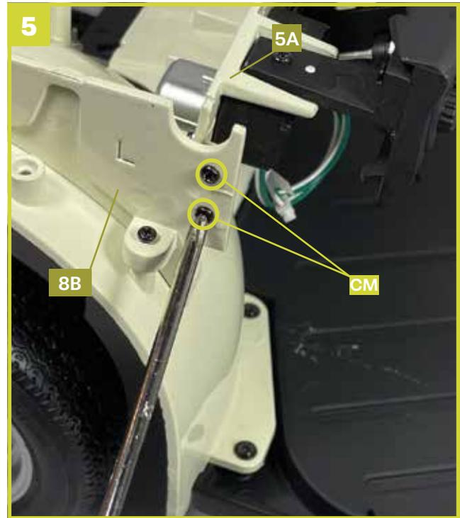
Fixieren Sie mit zwei weiteren Schrauben **CM** die Spritzwand **5A** auch am linken Motorraum-Seitenteil **8B**.
