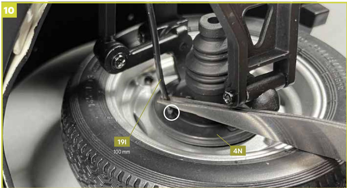
Verbinden Sie das andere Ende des 100 mm langen Schlauchs mit dem entsprechenden Ventil der Bremsankerplatte **4N**.
