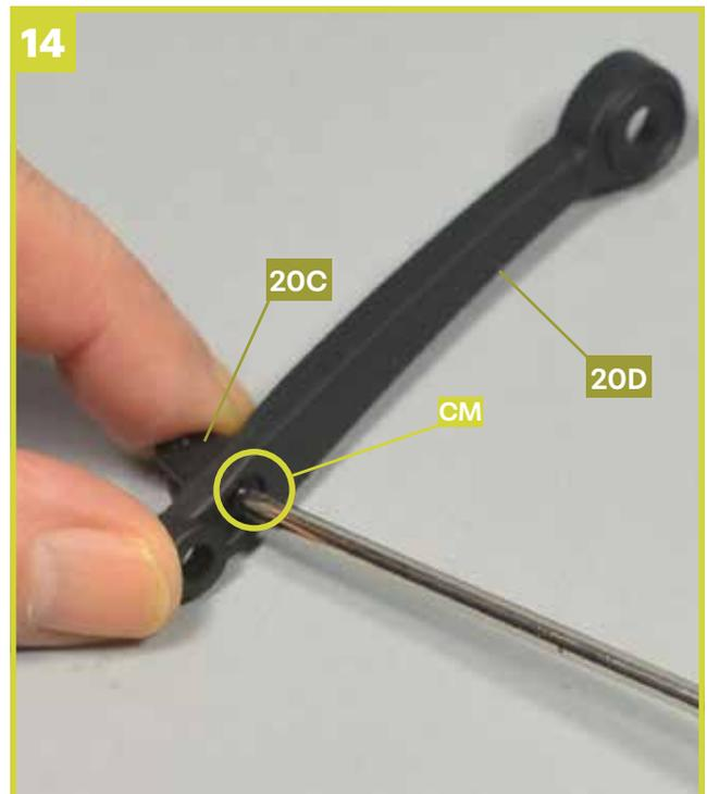
Fixieren Sie den Lagerblock **20C** mit einer Schraube **CM** am hinteren Lenkerarm B (links) **20D**.
