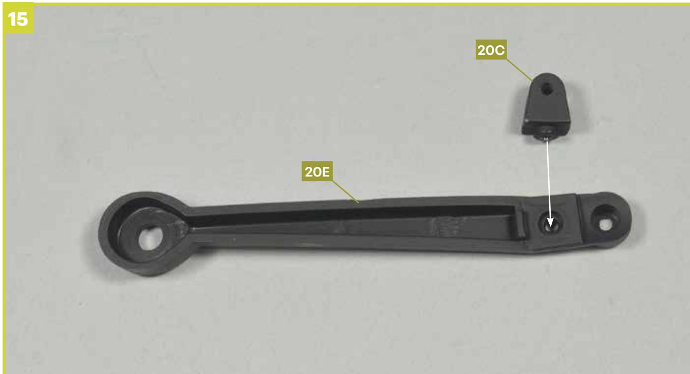
Setzen Sie den zweiten Lagerblock **20C** wie angedeutet in den hinteren Lenkerarm B (rechts) **20E**.
