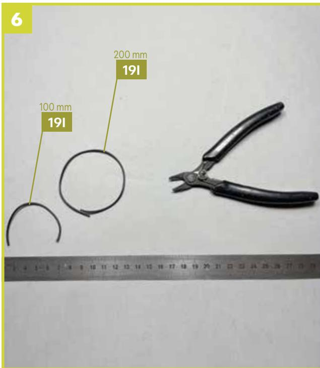
Schneiden Sie mithilfe eines Seitenschneiders ein 100 mm langes und ein 200 mm langes Stück vom Schlauch **191**.
