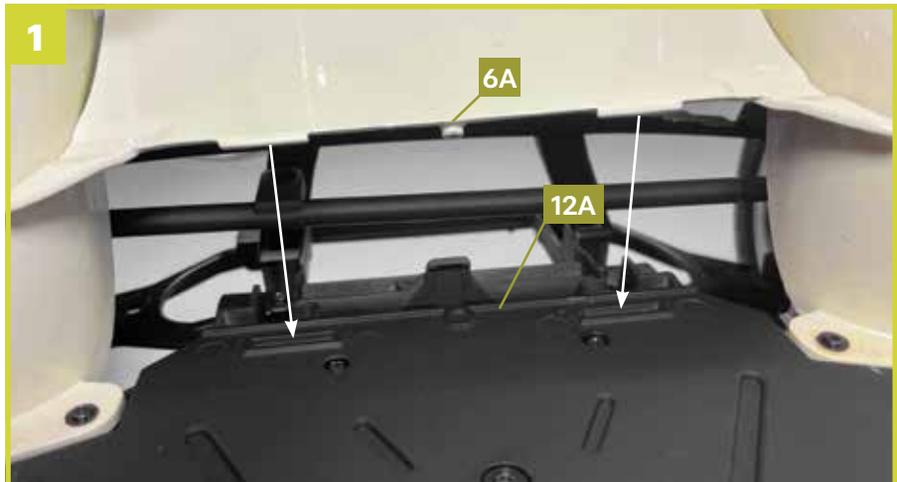
Verbinden Sie das Spritzwand-Unterteil **6A** mit dem mittleren Bodenblech **12A**, indem Sie die zwei Laschen wie angedeutet ausrichten.
