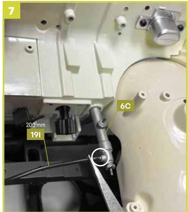
Verbinden Sie ein Ende des 200 mm langen Schlauchs mit dem gezeigten Ventil des Hauptbremszylinders **6C**.
