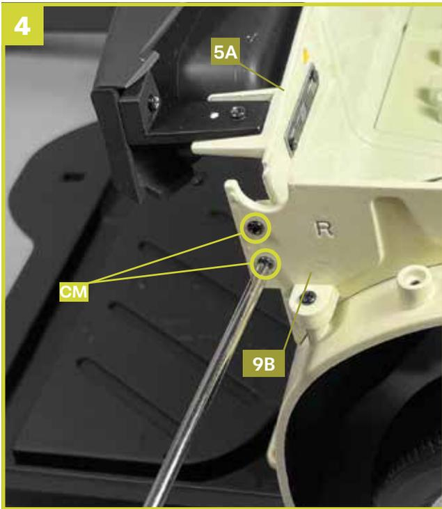
Befestigen Sie die Spritzwand **5A** mit zwei Schrauben **CM** am rechten Motorraum-Seitenteil **9B**.
