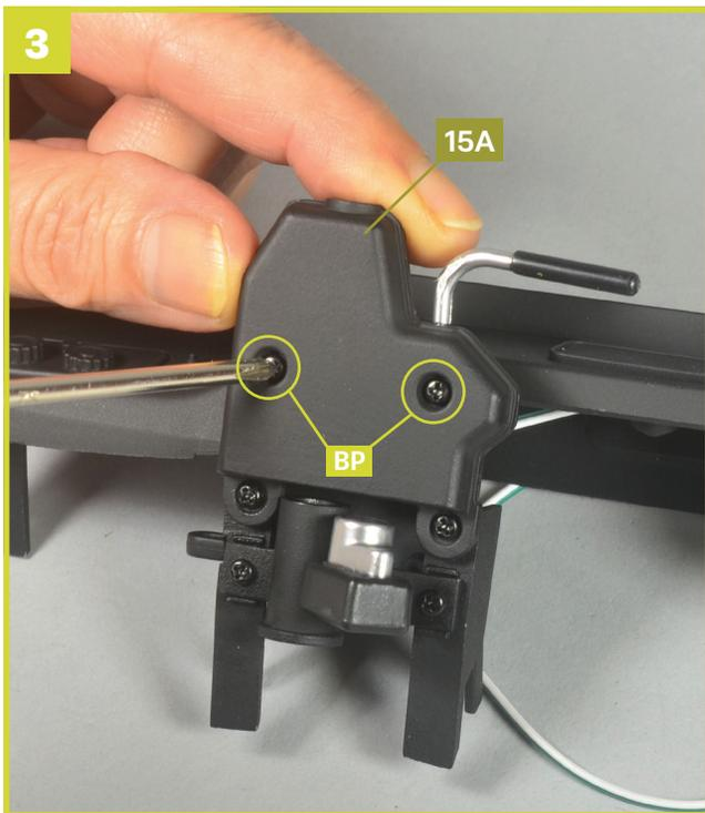
3 Verbinden Sie das Unterteil **15A** und das Oberteil **16A** der Lenksäulenvorrichtung miteinander. Befestigen Sie die beiden Bauteile mit zwei Schrauben **BP**.
