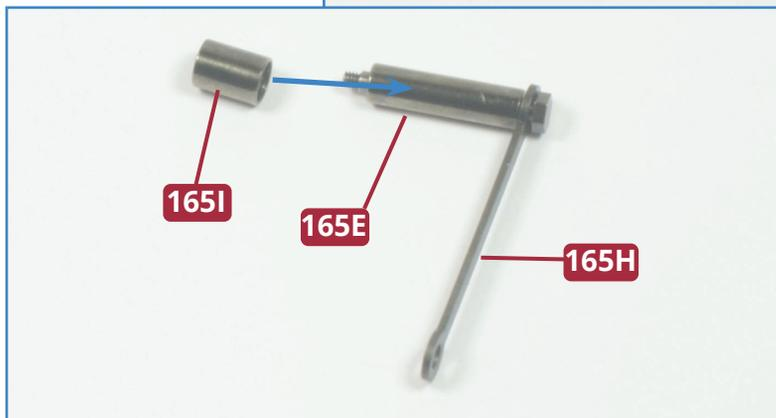
**1** Führen Sie den Schraubbolzen **165G** durch die Öse am einen Ende einer der beiden Stangen **165H** (ganz links). Über den Bolzen schieben Sie zunächst die lange Hülse **165E** (links) und über diese eine der kurzen Hülsen **165I** (links unten). Setzen Sie den Verbinder **165B** auf die Baugruppe und schieben Sie ihn bis zur kurzen Hülse durch. Beachten Sie dabei die Position des kleinen Lochs am Verbinder (unten blau eingekreist)!
