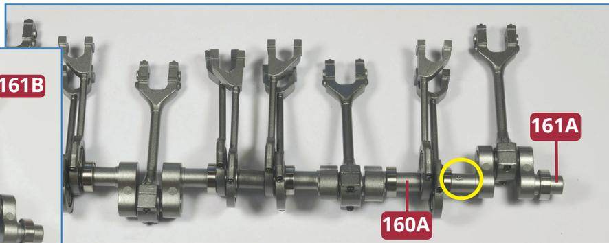
**4** Nehmen Sie die mit Schritt 2 gefertigte Kurbelwellen-Baugruppe und fügen Sie das abgeflachte Ende des langen Arms der Kurbelwelle **161A** in das freie Ende der Kurbelwelle **160A** ein (oben links und oben).
