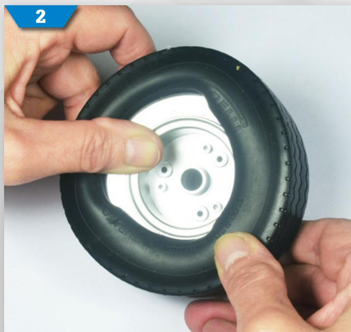
**2** Lassen Sie den Reifen einige Minuten lang in warmem Wasser einweichen, damit er weicher wird, und setzen Sie die Felge ein. Wenn Sie fertig sind, müssen die Reifenkanten perfekt auf beide Felgenflächen passen.
