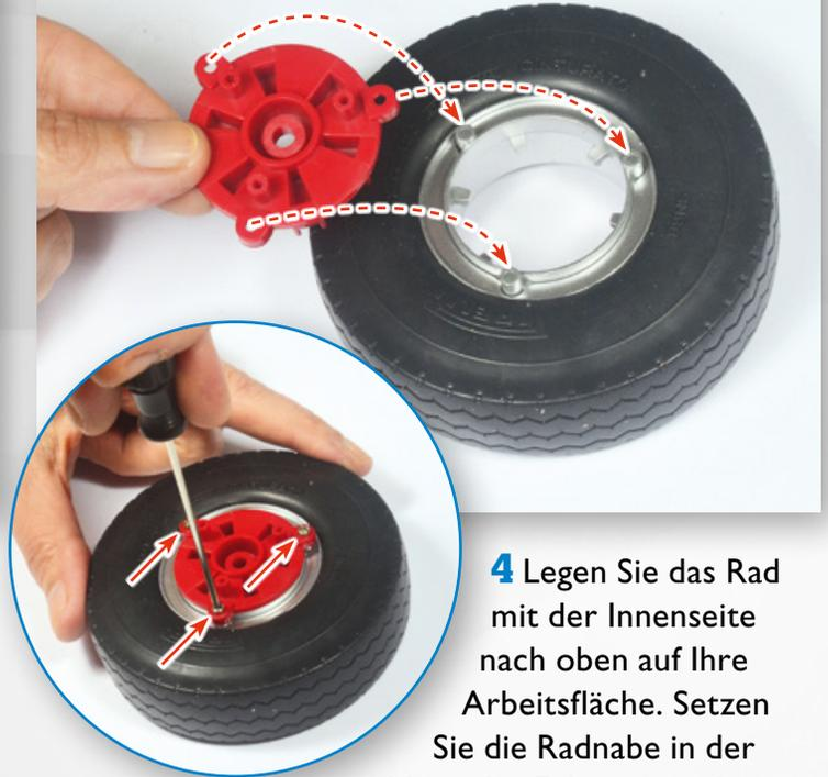
**4** Legen Sie das Rad mit der Innenseite nach oben auf Ihre Arbeitsfläche. Setzen Sie die Radnabe in der Mitte der Felge ein und richten Sie die Teile wie gezeigt aus. Befestigen Sie die Teile aneinander, indem Sie drei PS02-Schrauben in den durch die Pfeile im runden Bild markierten Löchern anziehen.
