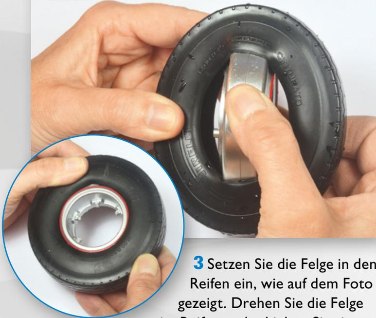
**3** Setzen Sie die Felge in den Reifen ein, wie auf dem Foto gezeigt. Drehen Sie die Felge im Reifen und schieben Sie sie nach und nach in den Reifen. Wenn Sie fertig sind, müssen die Reifenkanten perfekt auf beide Felgenflächen passen.
