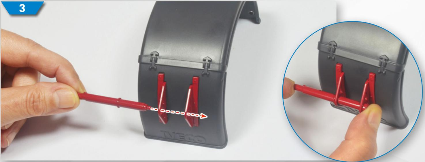
**3** Schieben Sie die vordere Stütze in die Löcher der Halterung und richten Sie die Teile wie auf dem Foto gezeigt aus. Schieben Sie die Stütze ganz hinein und setzen Sie den Sicherungsring mit leichtem Druck auf den Stift am Ende der Stütze.
