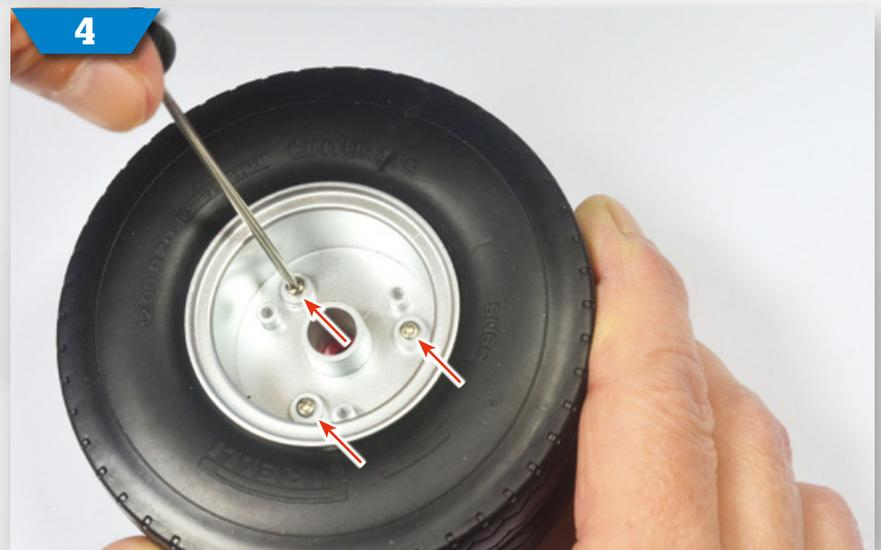
**5** Setzen Sie das Mittelteil der Felge in die Mitte des inneren Reifens. Befestigen Sie die Teile mit drei PS02-Schrauben aneinander.
