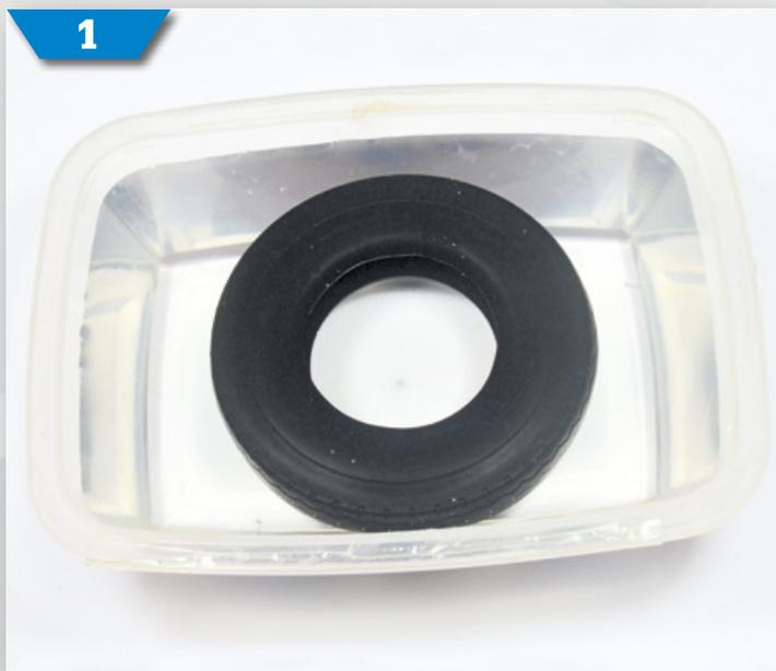
**1** Erhitzen Sie etwas Wasser und tauchen Sie den äußeren Reifen darin ein. Dadurch wird das Gummi weicher und Sie können den Reifen leichter auf die Felge aufziehen.
