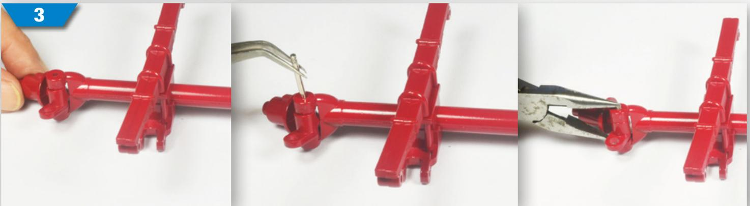
**3** Setzen Sie den linken Lenkhebel an das linke Ende der Achse, wie auf den Fotos gezeigt. Führen Sie das glatte Ende eines Stifts durch die Löcher von Achse und Hebel und drücken Sie ihn ganz durch.
