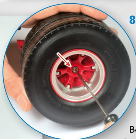
**8** Nehmen Sie jetzt die Zwillingerräder des Sattelauflegers aus Bauphase 32 und 35 zur Hand. Setzen Sie ein Rad auf ein Ende der Achse, wie auf dem Foto gezeigt. Befestigen Sie die Teile mit einer DS25-Schraube, aber ziehen Sie sie nicht ganz fest: Das Rad muss sich ungehindert drehen können.
