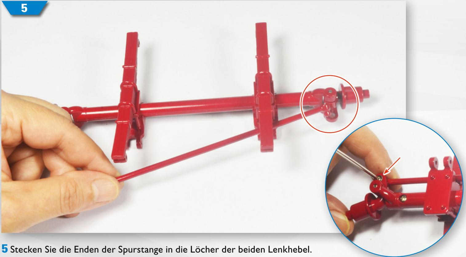
**5** Stecken Sie die Enden der Spurstange in die Löcher der beiden Lenkhebel. Drehen Sie die Baugruppe um und befestigen Sie die Teile aneinander, indem Sie zwei DS26-Schrauben in den Löchern der Lenkhebel anziehen.
