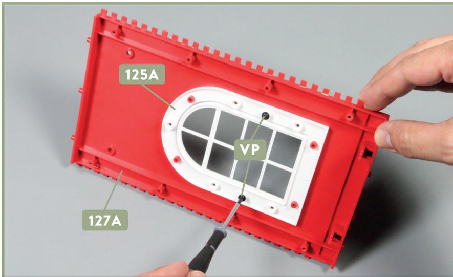
**2** Befestigen Sie das Fenster **125A** mit zwei Schrauben **VP** am Fassadenabschnitt **127A**, wie es das Foto zeigt.
