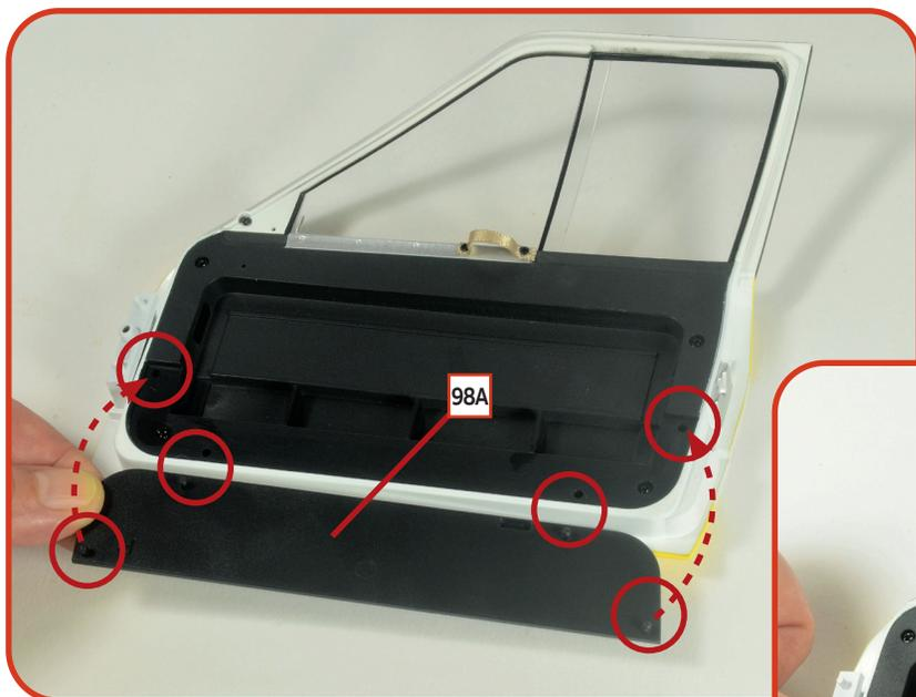
**03** Bringen Sie die Türverkleidung **98A** an der vorgesehenen Stelle am unteren Teil der Türinnenverkleidung an. Setzen Sie dabei die Stifte in die entsprechenden Löcher ein und üben Sie leichten Druck auf die gesamte Oberfläche des Teils aus, um es korrekt zu befestigen.
