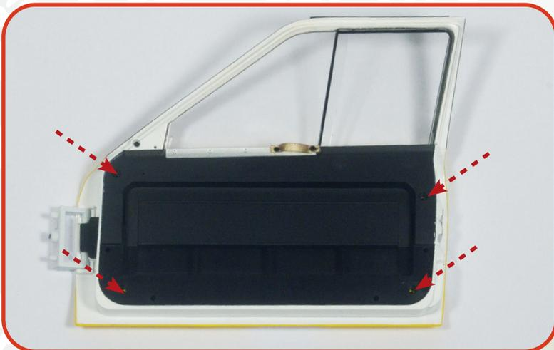
**02** Befestigen Sie die Bauteile, indem Sie vier **SM**-Schrauben in den markierten Löchern festziehen.
