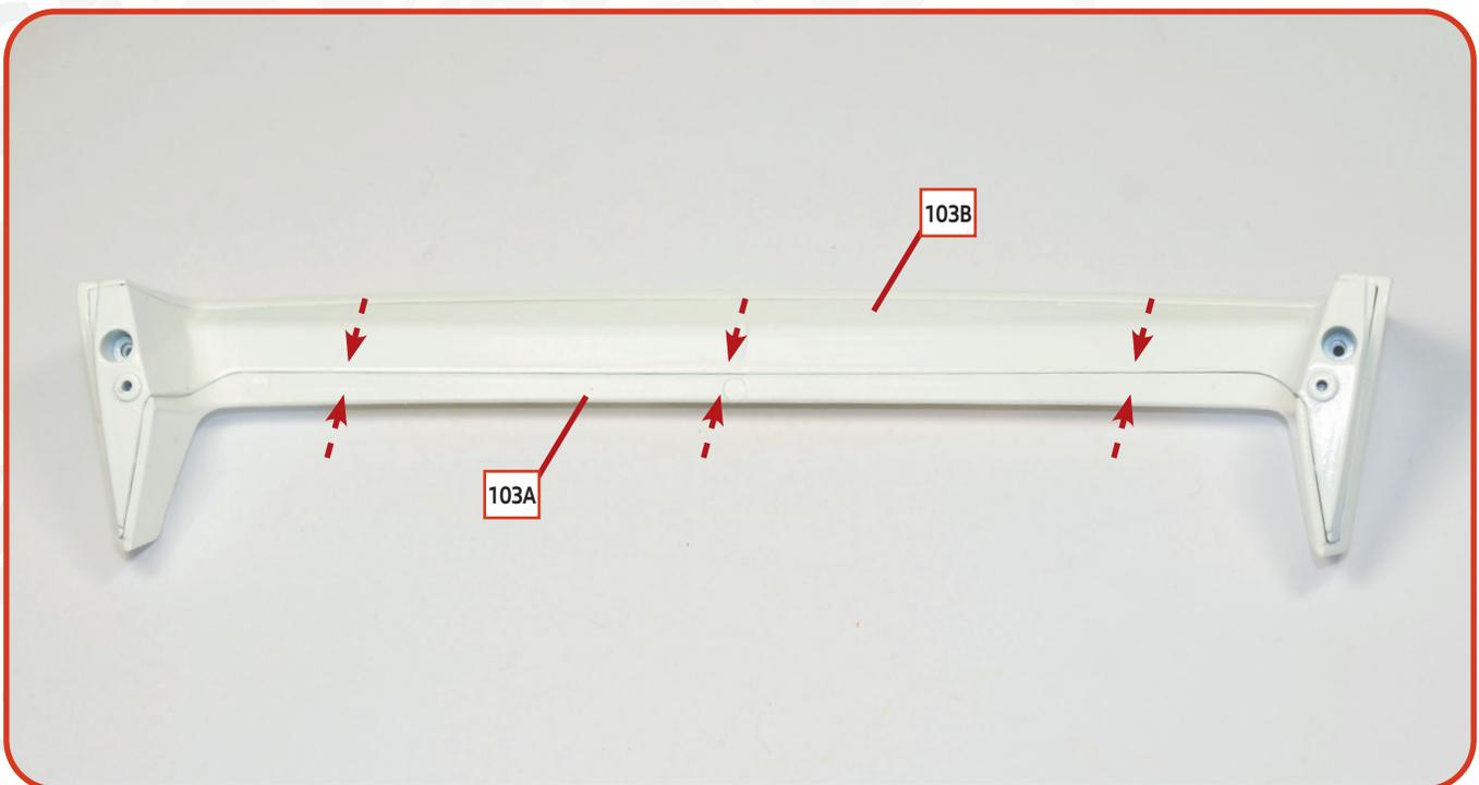
**02** Prüfen Sie, ob das Innenteil des Heckspoilers vollständig in das Außenteil eingesetzt wurde.
