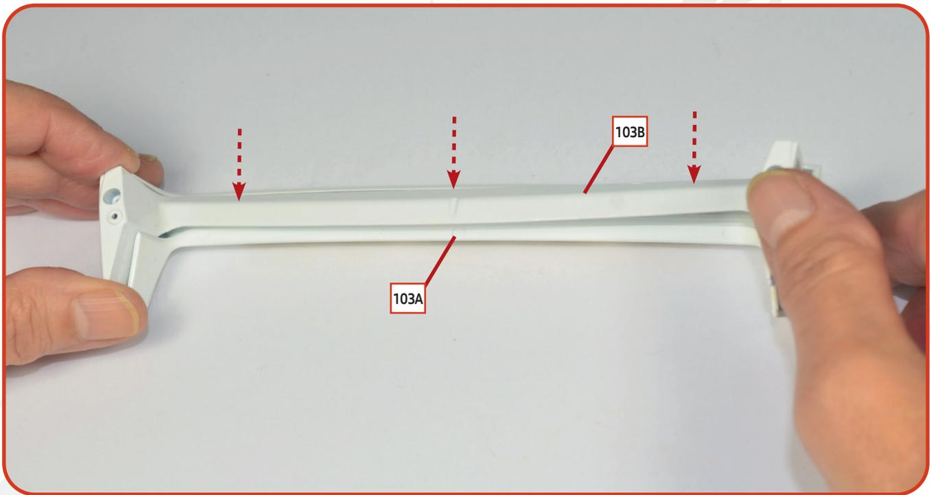
**01** Stecken Sie das Innenteil des Heckspoilers **103B** an der vorgesehenen Stelle in das Außenteil **103A**.
