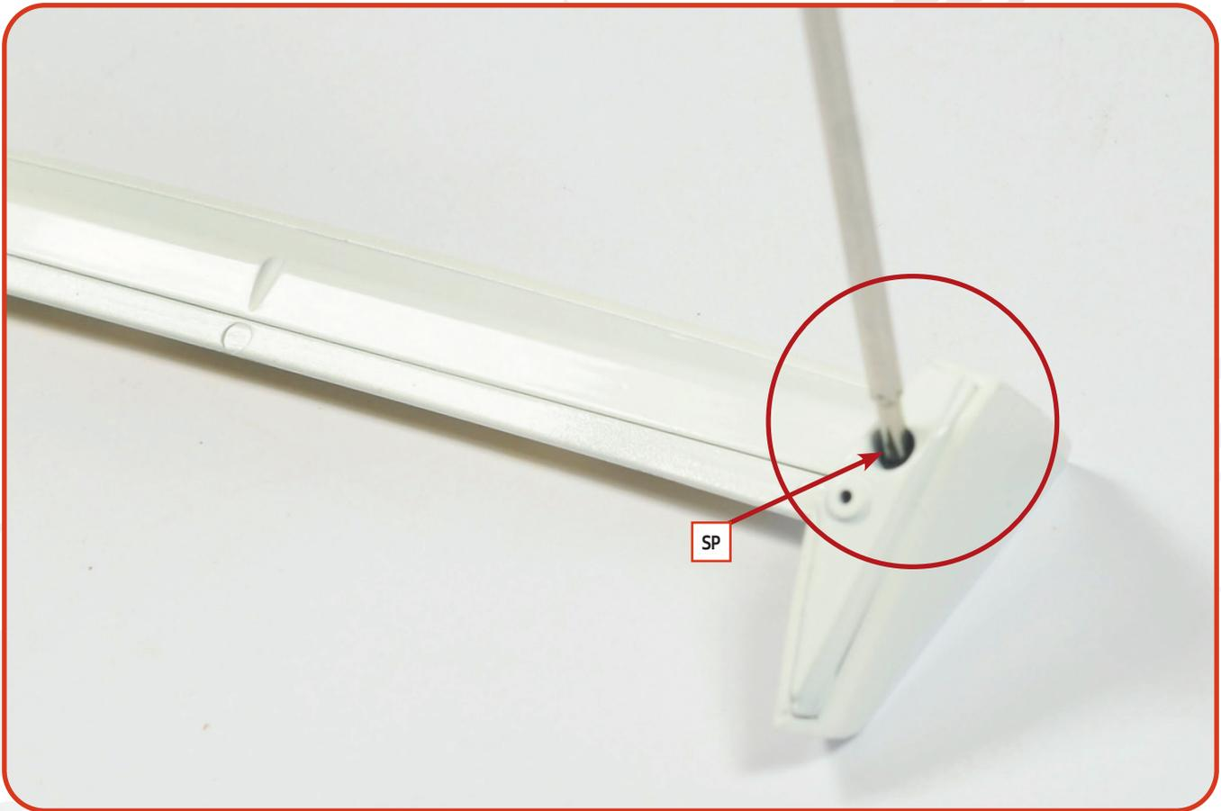
**05** Schließen Sie die Befestigung der Bauteile ab, indem Sie jetzt auch die zweite **SP**-Schraube in das andere Loch auf der Innenseite des Heckspoilers eindrehen.
