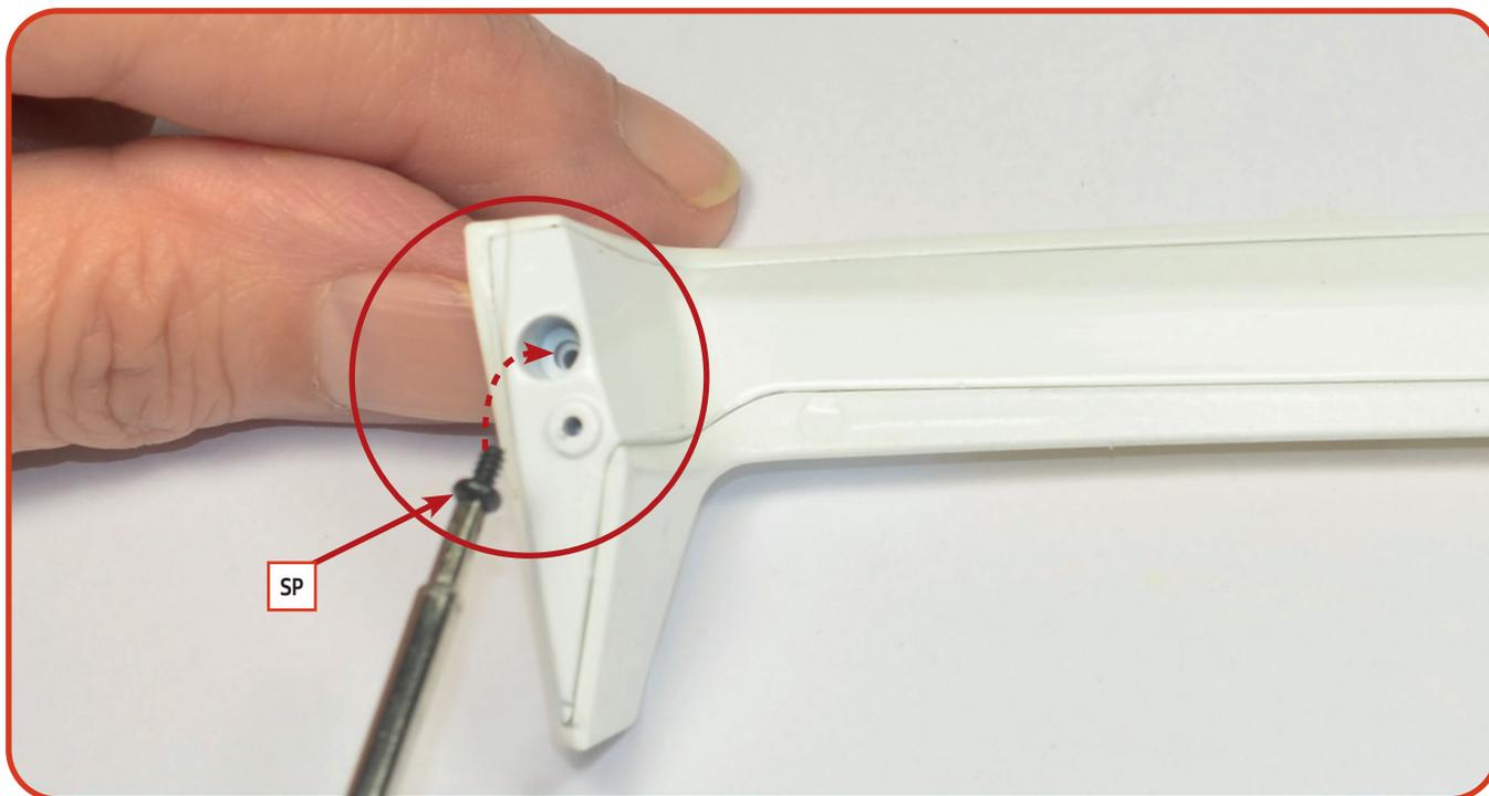
**03** Sie benötigen zwei **SP**-Schrauben, um die Teile miteinander zu verbinden. Bringen Sie die erste Schraube in die Nähe eines der Löcher auf der Innenseite des Heckspoilers.
