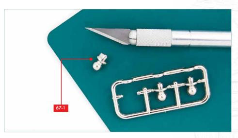
Détachez de leur cadre les trois rotules **67-1** et lissez les irrégularités aux points de fixation à l'aide d'une lime de finition.
