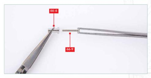
Insérez une vis KM **66-9** dans le trou du manchon de vis **66-6**.
